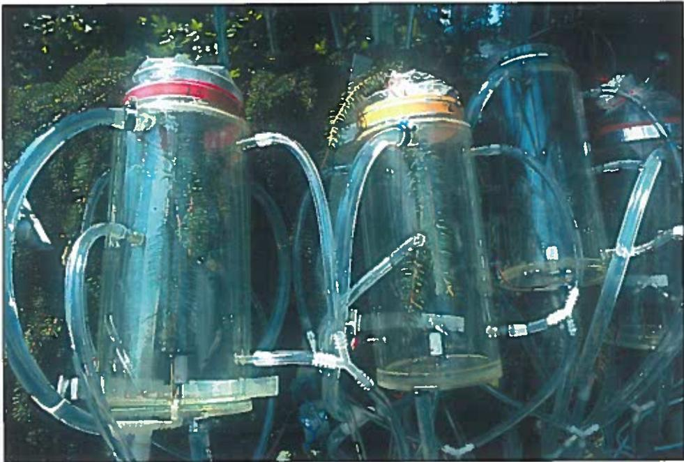
Die zylindrischen Begasungsküvetten waren aus Plexiglas mit hohem Transmissionsgrad ( $> 90\%$ ) im Bereich der photosynthetisch aktiven Strahlung gefertigt. Somit konnte die Sonnenstrahlung im pflanzenphysiologisch wirksamen Bereich nahezu unvermindert auf die Zweige einwirken.
