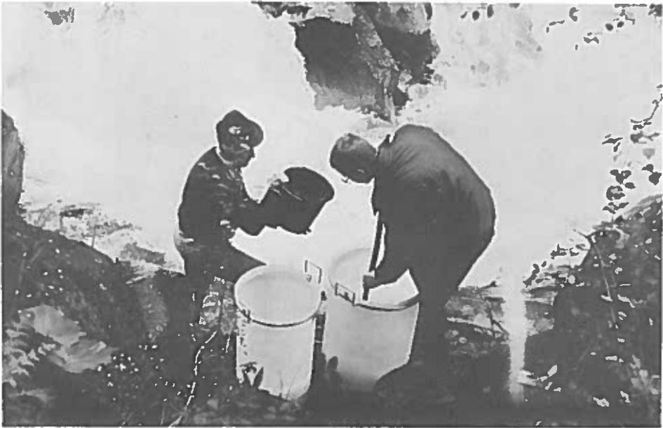
Abb. 7: Fließzeitmessung; Herstellen der Tracerlösung zur Einspeisung
