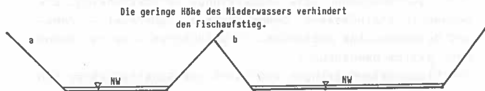
Abb. 53: Schalenbauweise, die jeden Fischaufstieg unterbindet und auch aus Gründen der Landschaftsökologie völlig abzulehnen ist.
