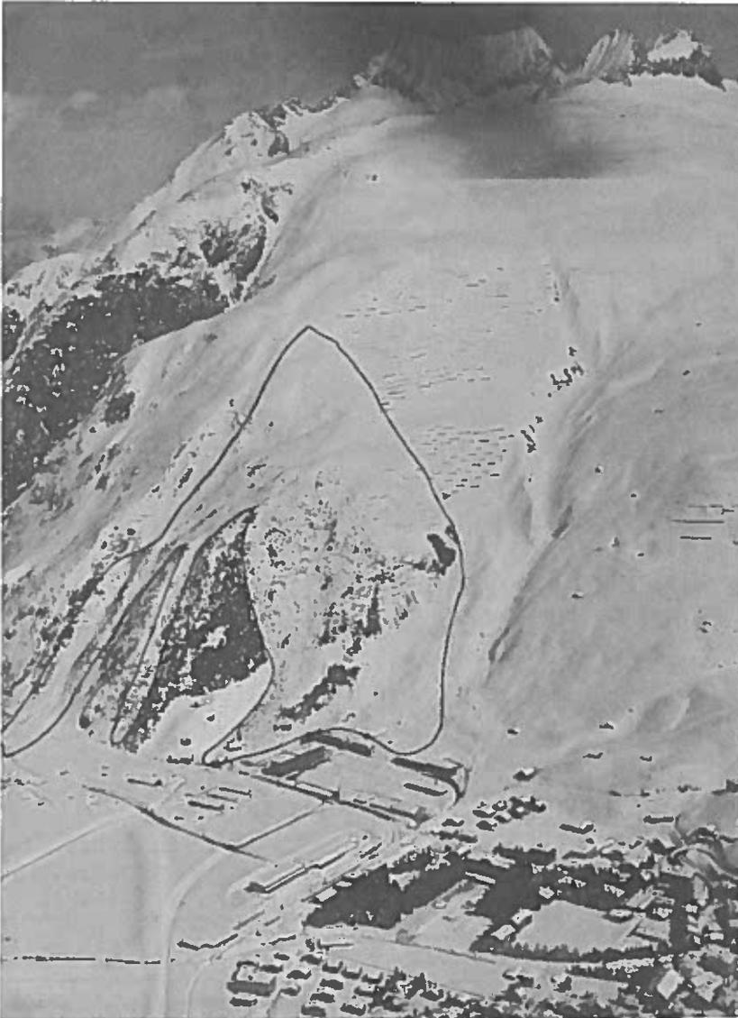
**Bild 6** Kirchberg/Andermatt, Kanton Uri: Lawine vom 6. April 1975 mit Anbruchgebiet links der permanenten Stützverbauung und mit Sturzbahnen über verbaute und aufgeforstete Hänge.
