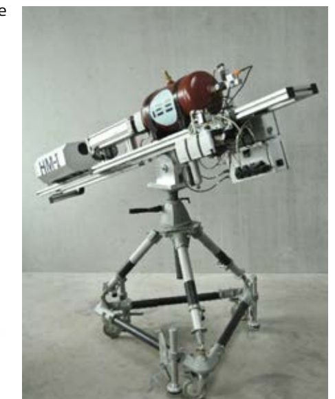
Figure 2: Hagelregister ( www.hagelregister.at ) und Hagelsimulationsmaschine /Hagelkanone
