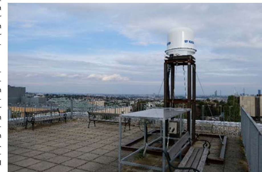
Abbildung 1: Montage der Radarkuppel auf der Dachplattform.
