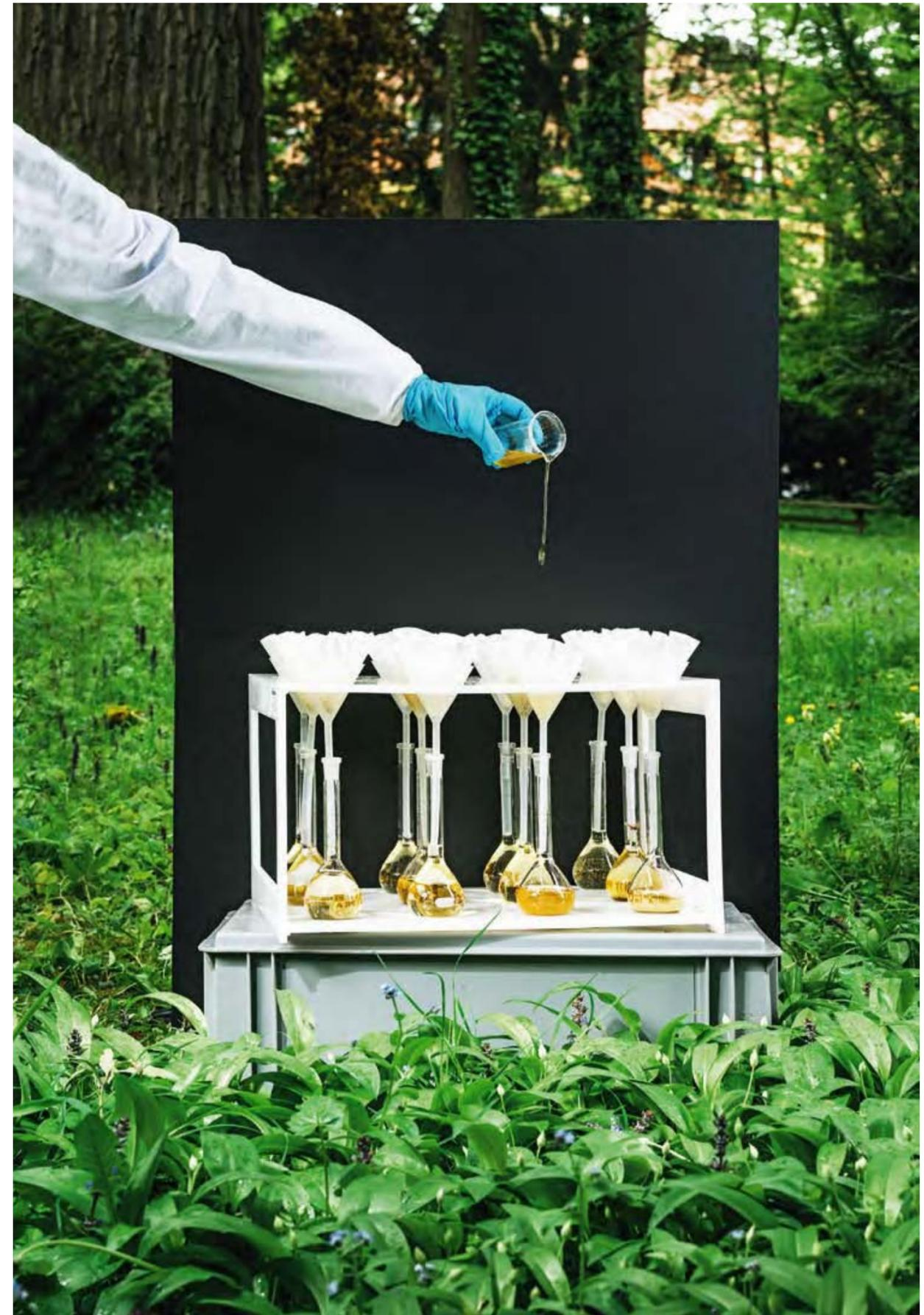
Bei dieser Filteranlage handelt es sich um eine Sonderanfertigung. Bei der Prozedur geht es darum, Bodenextrakte herzustellen, um den langjährigen Vorrat von Nährstoffen und Schwermetallen genau eruieren zu können.
