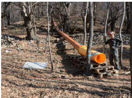
Abb. 7. Steinschlagversuche an adulten Götterbäumen mit einer 50 kg schweren Granitkugel bei San Vittore (GR). Rechts: Energieaufnahme Kapazität des Götterbaums im Vergleich zur Buche (Moos et al. 2019). Werte oberhalb der roten 1:1-Linie zeigen eine erhöhte Energieaufnahme Kapazität der Buche.
