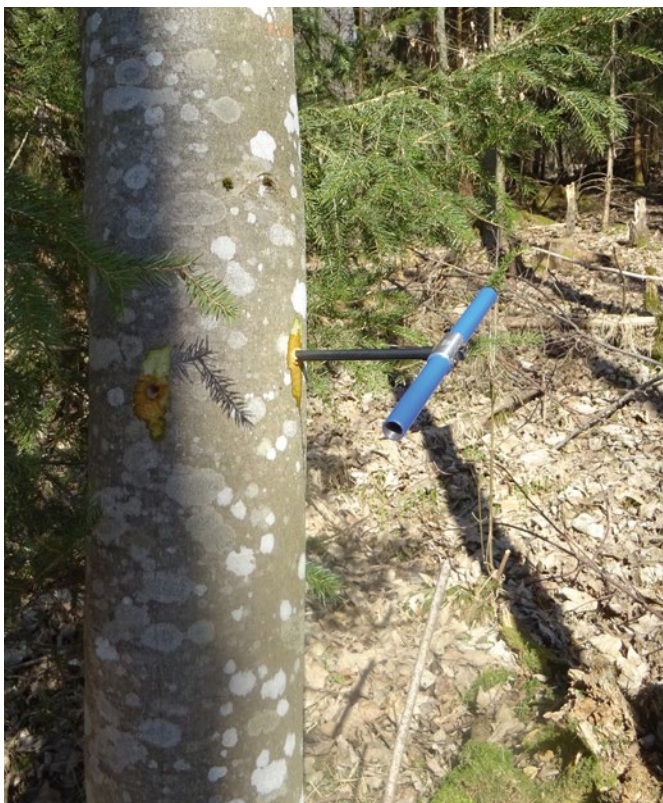
ABBILDUNG 1: Beprobung der Bäume mit einem Zuwachsbohrer während der zweiten Kampagne (Bild: N. Burgdorf).
