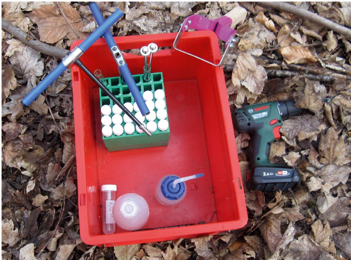
ABBILDUNG 2: Material zur Probenahme und Reinigung: Bohrmaschine zum Vorbohren, Reagenzgläser mit Wasserstoffperoxid zur Reinigung der Utensilien, Spritzflasche mit Wasser zum Nachspülen, Schabeisen zum Entfernen der äußeren Rinde und Gefäße zur Probennahme.
