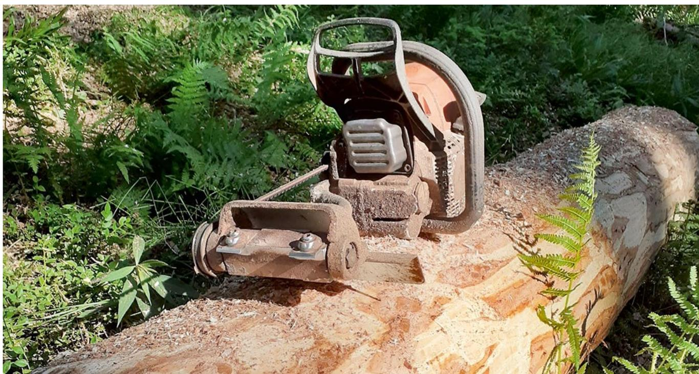
**ABBILDUNG 2:** Eder Schälgerät ESG1, montiert auf der Motorsäge Stihl MS 362 C. Das Gerät steht auf einem bereits vollständig entrindeten Bloch.
