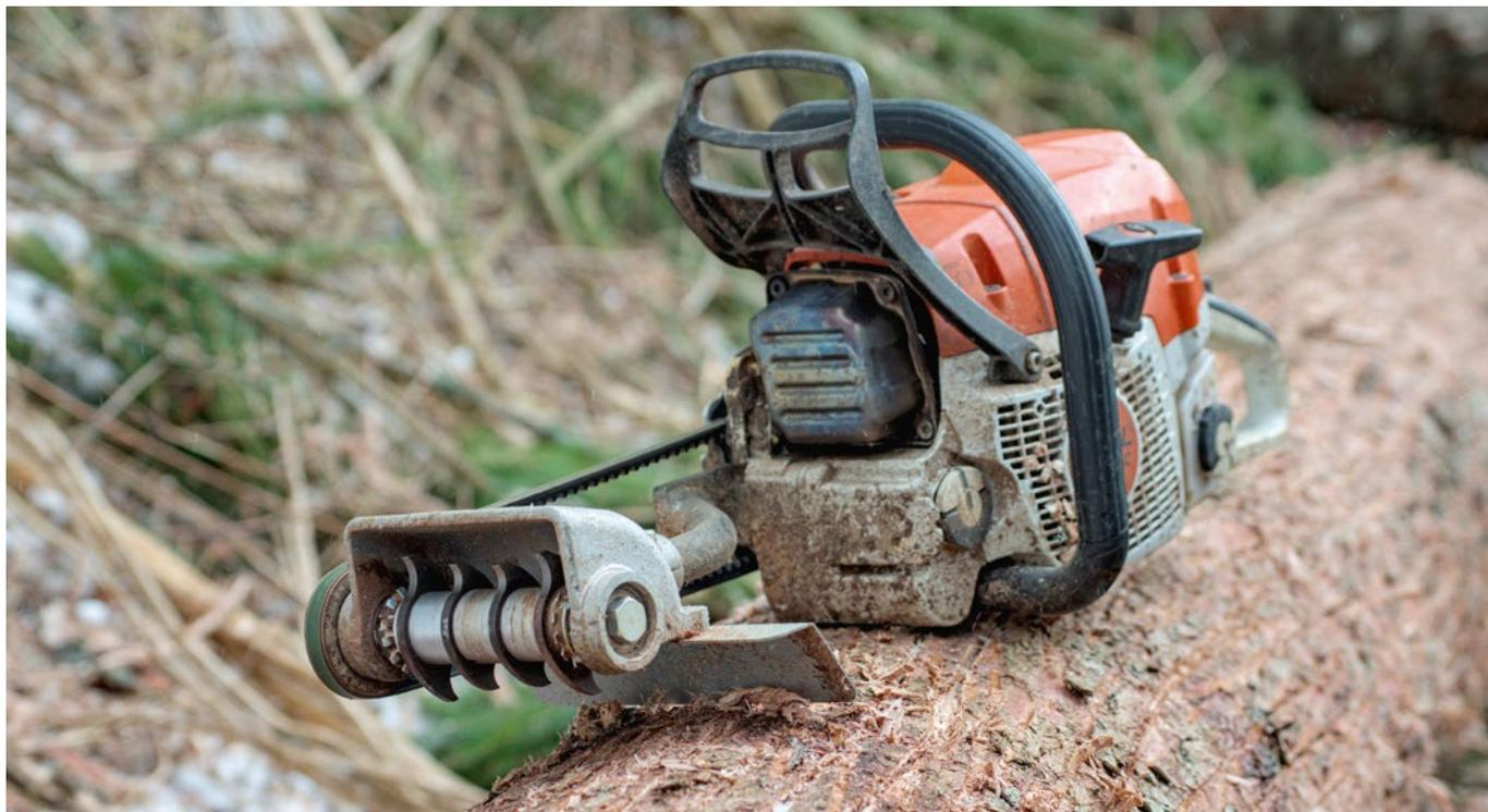
**ABBILDUNG 1:** Eder Borkenkäferfräse EBF1, montiert auf der Motorsäge Stihl MS 362 C. Das Gerät steht auf einem bereits vollständig geritzten Bloch.
