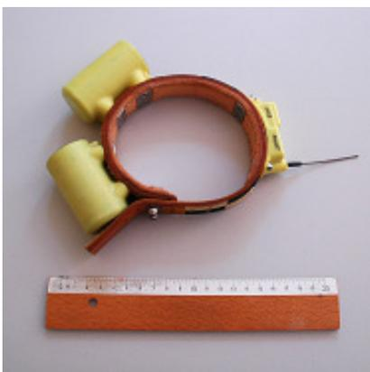
Abb. 2: GPS-Sender der Firma E-Obs GmbH.
