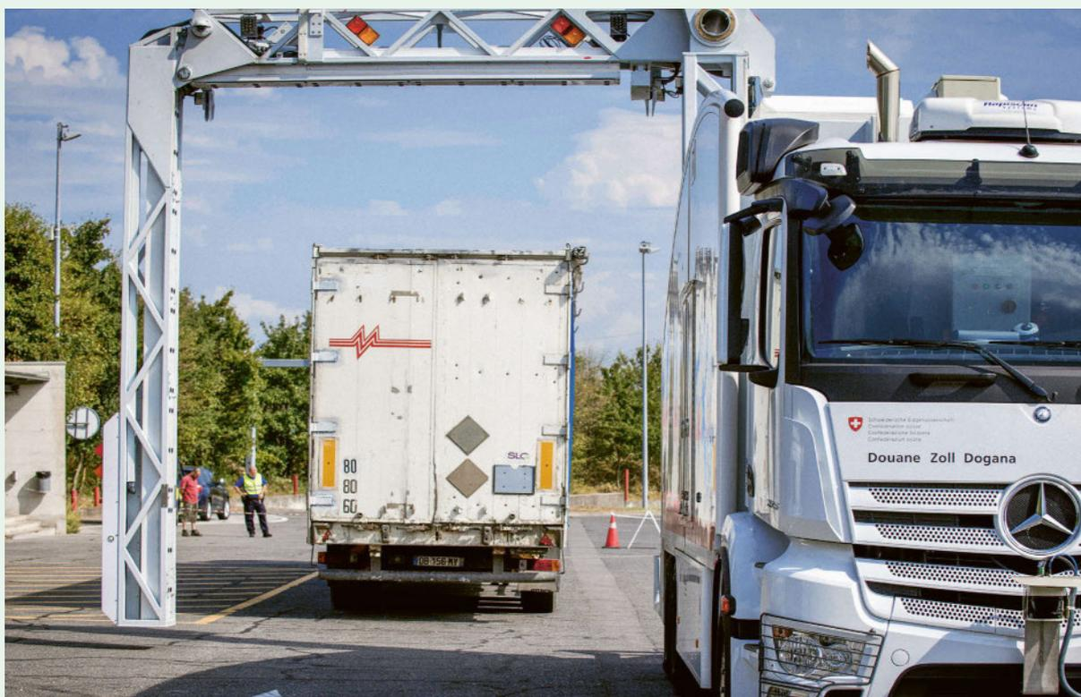
Mit dem mobilen Scanner lassen sich versteckte Waren nicht nur in der Ladung identifizieren, sondern auch in Strukturen, Kabinen und Türen.
