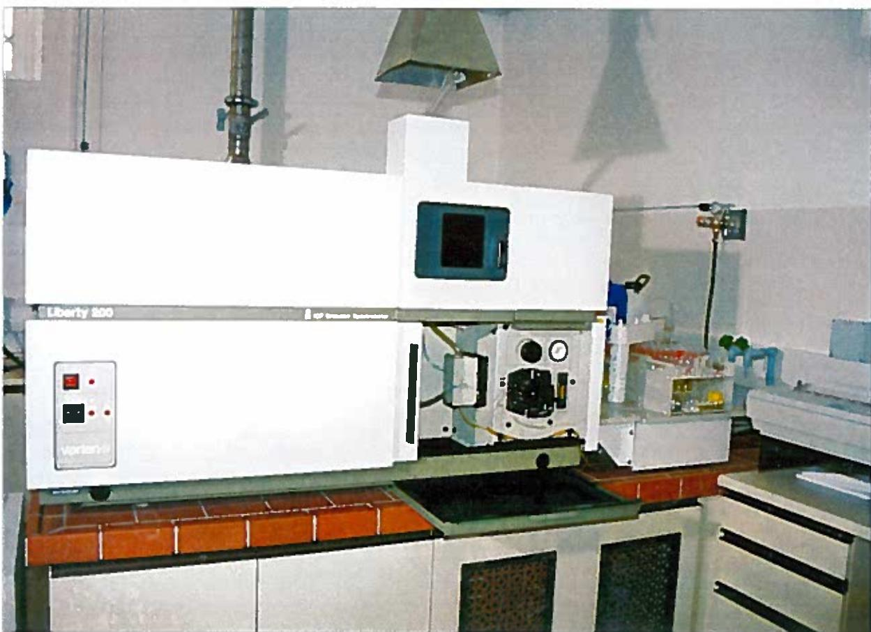
*ICP-Gerät für Blattanalysen; es bestimmt die Gehalte von Phosphor, Kalium, Calcium, Mangan, Eisen, Magnesium und Zink in Pflanzenproben.*
