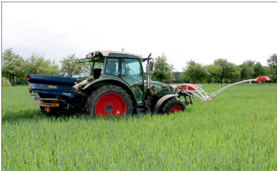
Einsatz eines Düngerstreuers mit einem Stickstoff-Sensor
