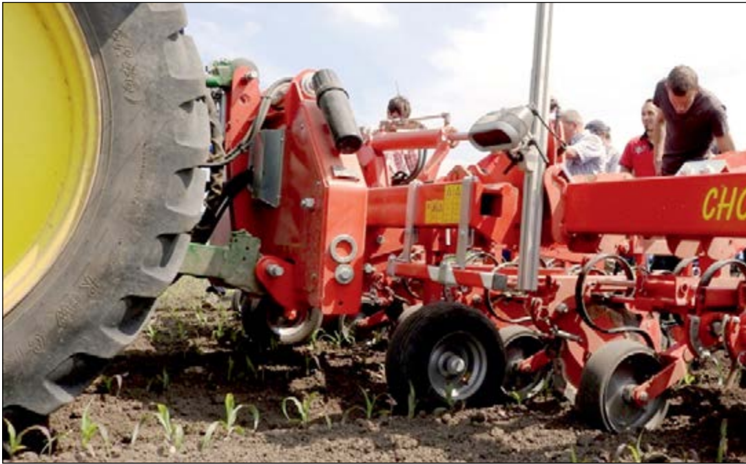
Die Kamera steuert den Verschubrahmen des Hackgerätes.
