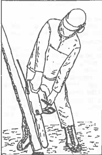
Schrägschnitt und Längenmessung mit der Motorsäge (Abläng-einrichtung)
