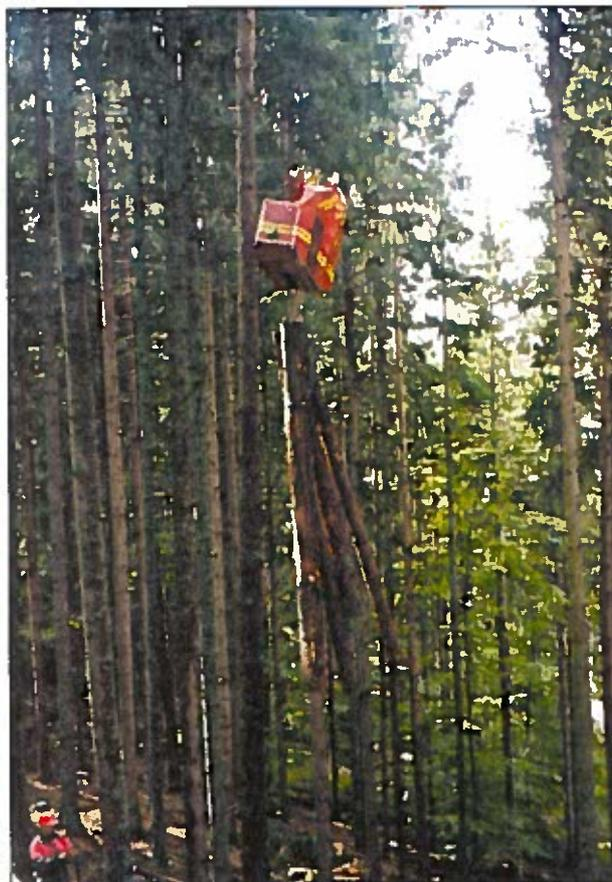
Abb. 9: Selbstfahrender Laufwagen Woodliner
