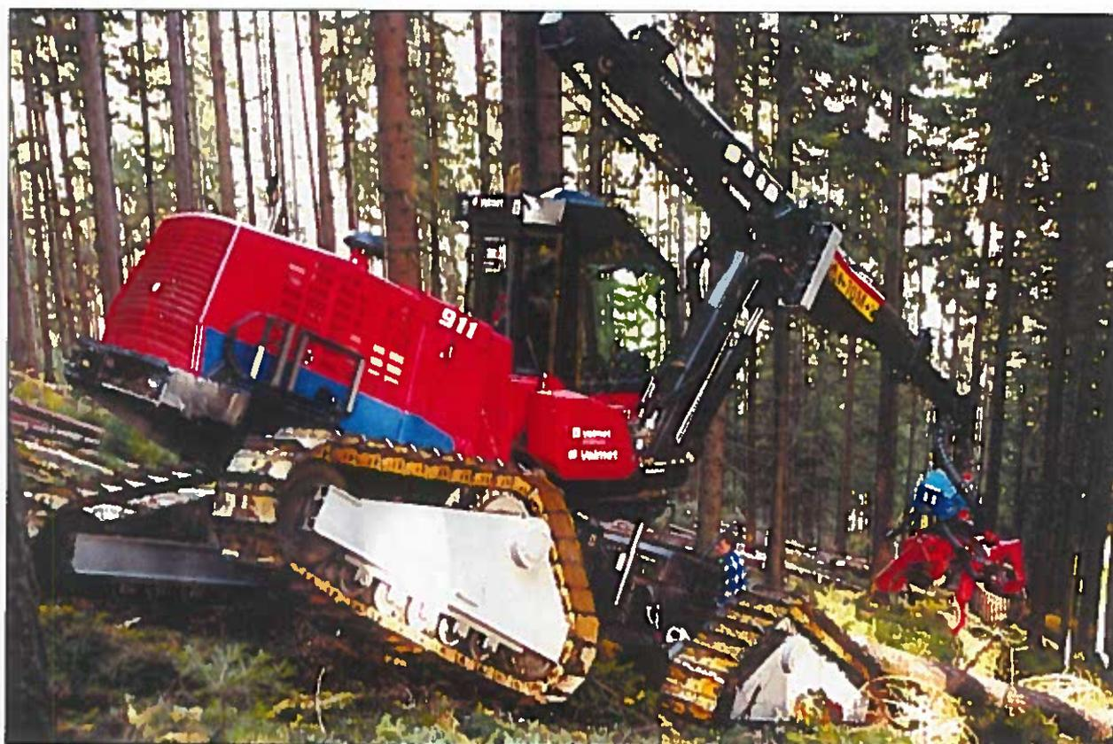
Abb. 14: Harvester Valmet 911 mit Raupenfahrwerk
