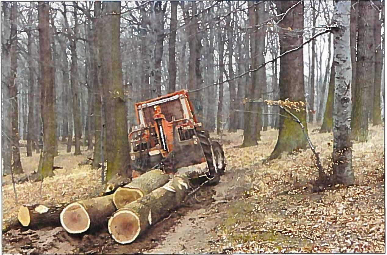
Abb. 3: Forstraktor mit Dreipunkt-Anbauwinde
