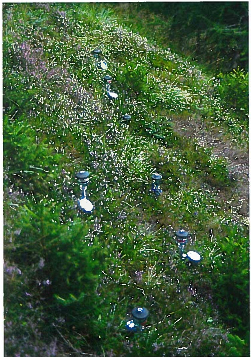
Druckänderungen, wie sie beim Nachfüllen bei höherem Austrocknungsgrad des Bodens (> 500 hPa) aus dem Wasserreservoir der Jet-Fill Tensiometer auftreten, nicht verkraften, und nach mehrmaliger solcher Beanspruchung kollabieren.
