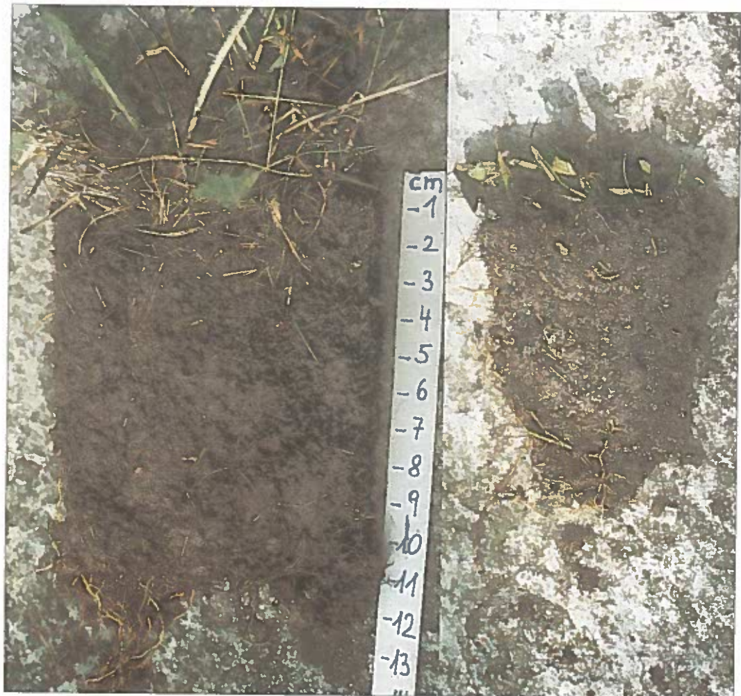
Abb. 4: Einfluß des Beweidungsschutzes auf die Lockerung des Bodens, links innerhalb, rechts außerhalb des Weidezaunes
