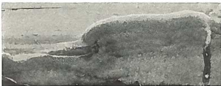
Abb. 28. Poroide Fruchtkörperbildung des Zaunblättlings ( Lenzites saepiaria ) hat sich auf der Unterseite eines eingebauten Brettes entwickelt (nat. Gr. — phot. K. Lohwag)
