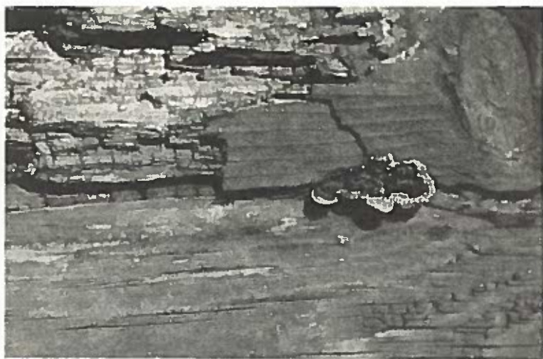
Abb. 27. Zaunblättling ( Lenzites saepiaria ), aus einem braunfaulen Balken auf natürlichem Standort hervorwachsend ( \frac{1}{3} d. nat. Gr. — phot. K. Lohwag)
