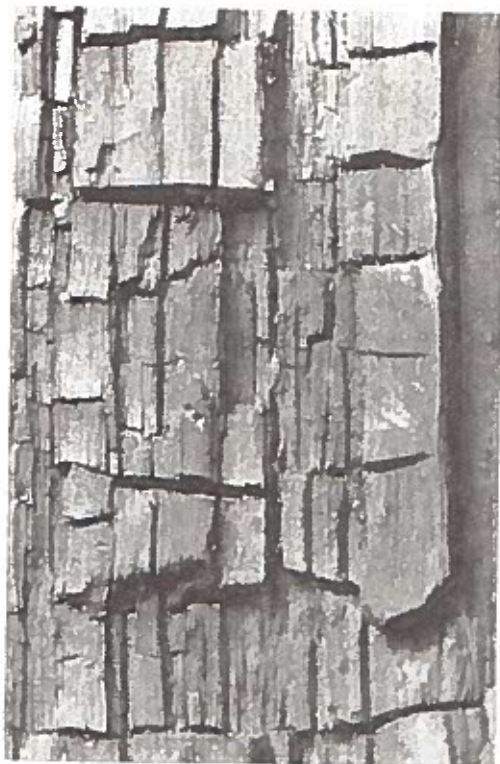
Abb. 2. Nadelholz, durch den echten Hausschwamm zerstört. Braunfäule mit typischem Würfelbruch
