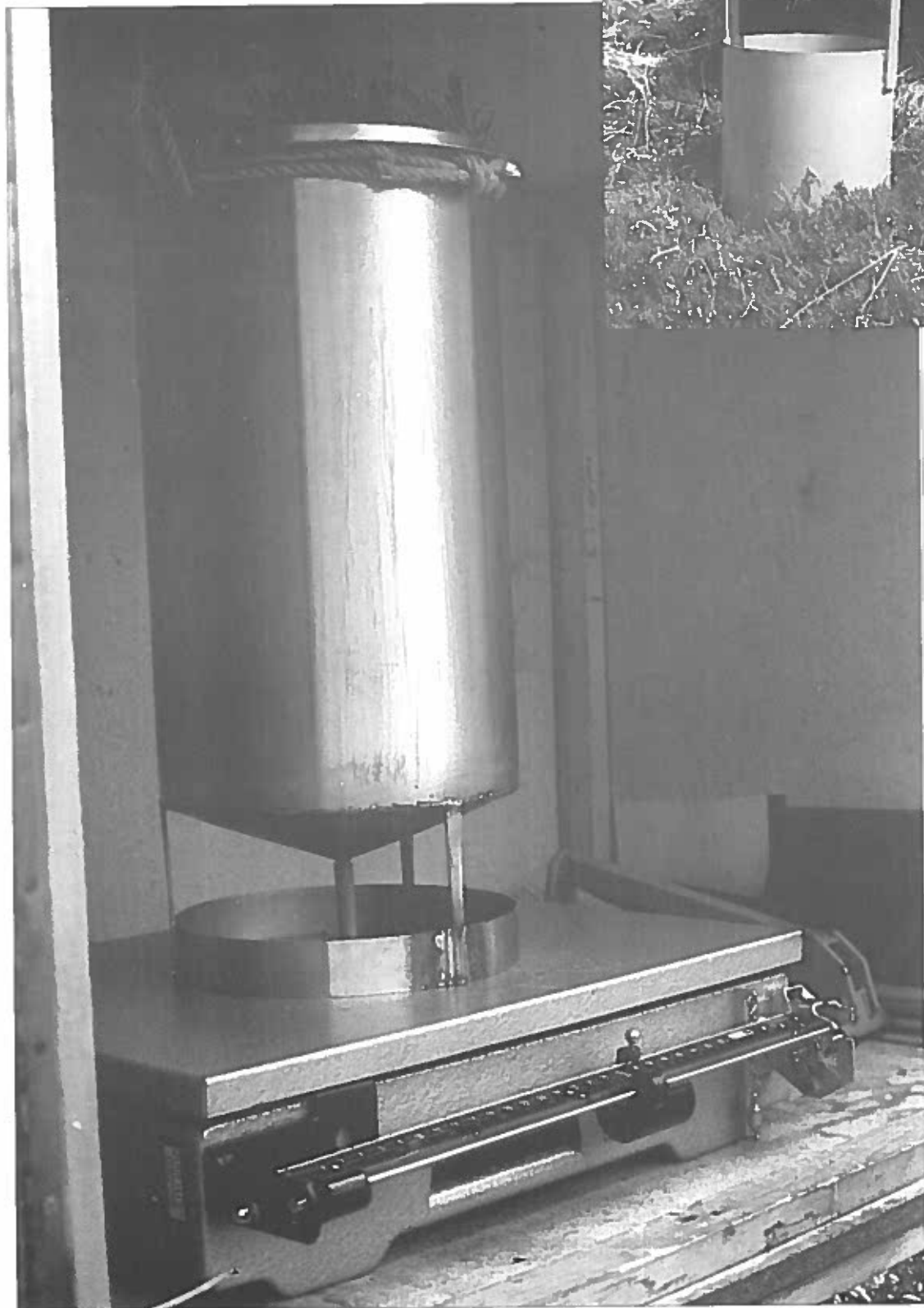
Abb. 91 Lysimetergefäß mit Waage Foto: P. Zwerger
