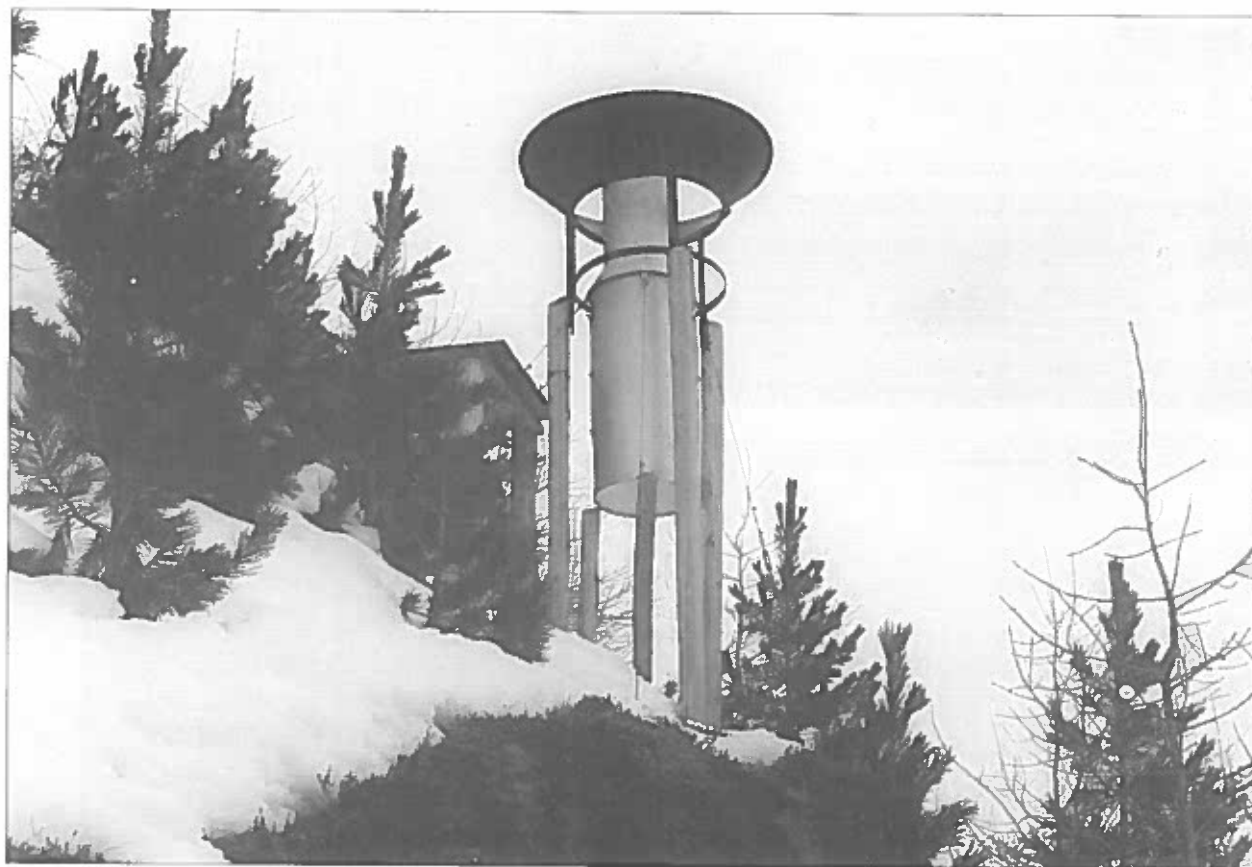
Abb. 83: BASIS I, Regen- Schneeschreiber mit Nipher-Ring, 3 m über dem Boden
