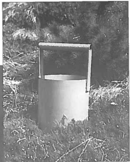
Abb. 91 Lysimetergefäß mit Waage Foto: P. Zwerger
