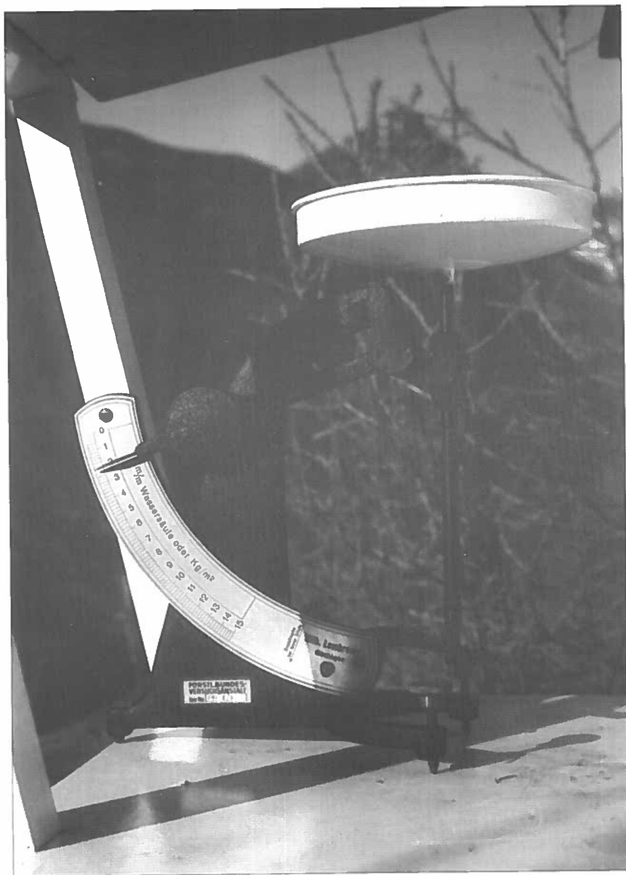
Abb. 86 Beschattete Wild'sche Waage, Standflächenbrett an der Wetterhütte; 2 m über dem Boden befestigt Foto: P. Zwerger
