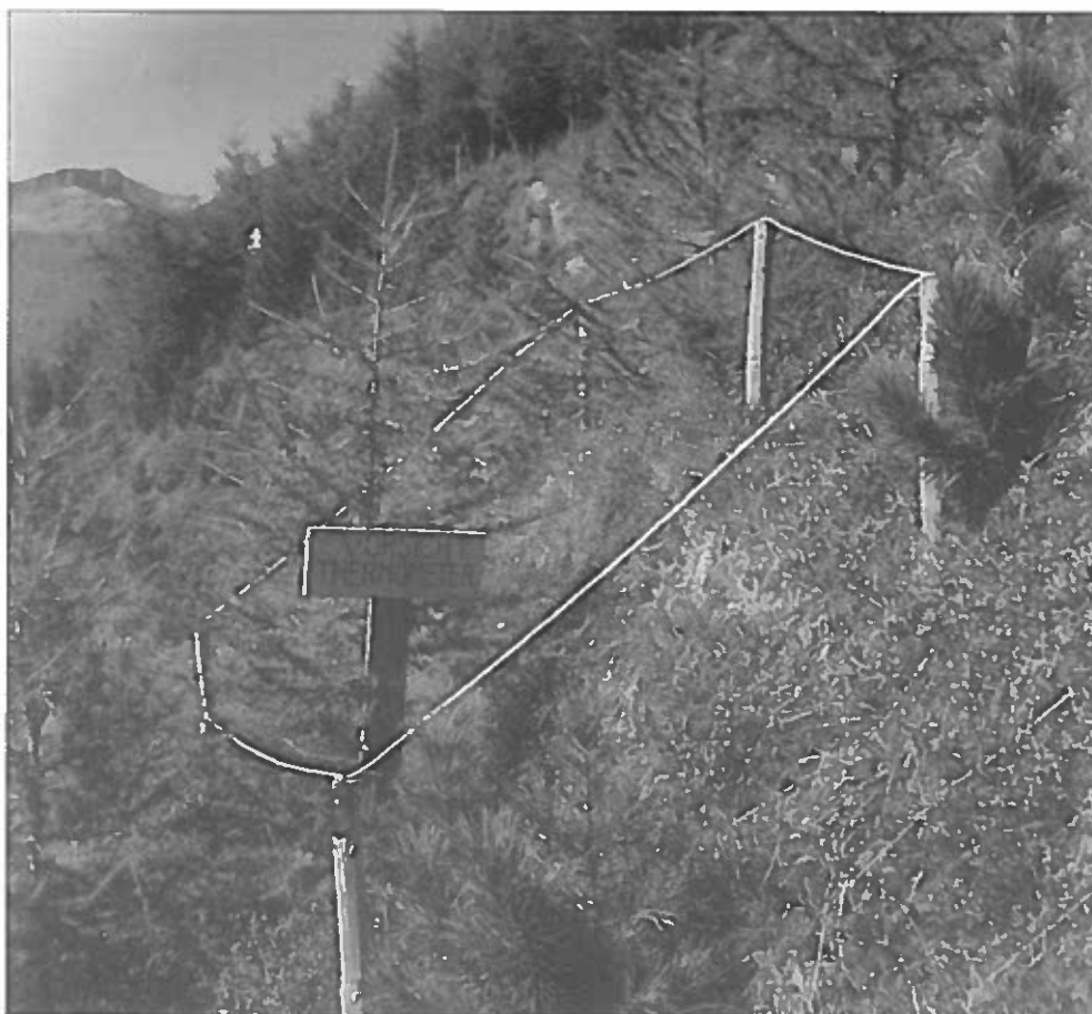
Abb. 37: Meßstelle, Basisstation II, Bodentemperaturmessung
