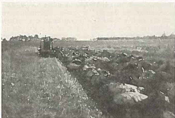
*Abb. 3a Scheibenpflug der Heidemaatschappij als Huckepackgerät, aufmontiert auf 60-PS-Raupe, beim Pflügen. (Holland. Aufnahme Mai 1951.)*
