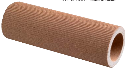
Abbildung 2: Mittels Extrusionsverfahrens hergestelltes duroplastisch gebundenes WPC-Rohr Foto: R. Rosin
