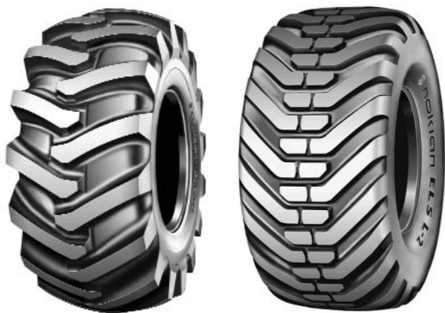
Abbildung 4: Traktionsprofil (links) und Implement-Traktionsprofil (rechts) Grafik: Nokian
