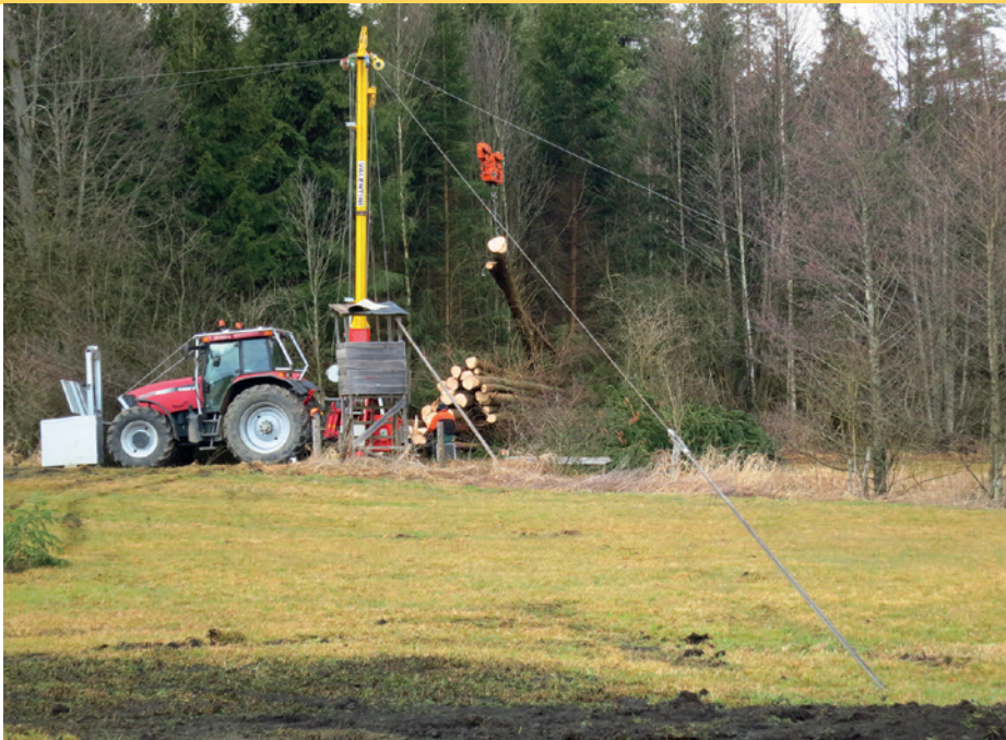
1 Der Schlepper mit Seilkranmast beim Rücken der Vollbäume; im Vordergrund rechts verschwindet ein Abspannseil im Boden – darunter befindet sich der Erdanker bzw. »Totmann«. Foto: R. Wende
