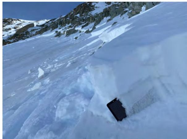
Abbildung 126: Im durchscheinenden Profil war die aufbauend umgewandelte Schicht über der Kruste mit dem Saharastaub gut sichtbar. Im Hintergrund ist auch der Saharastaub auf der Gleitfläche zu sehen (Foto: SLF/S. Harvey, 25.03.2021).
