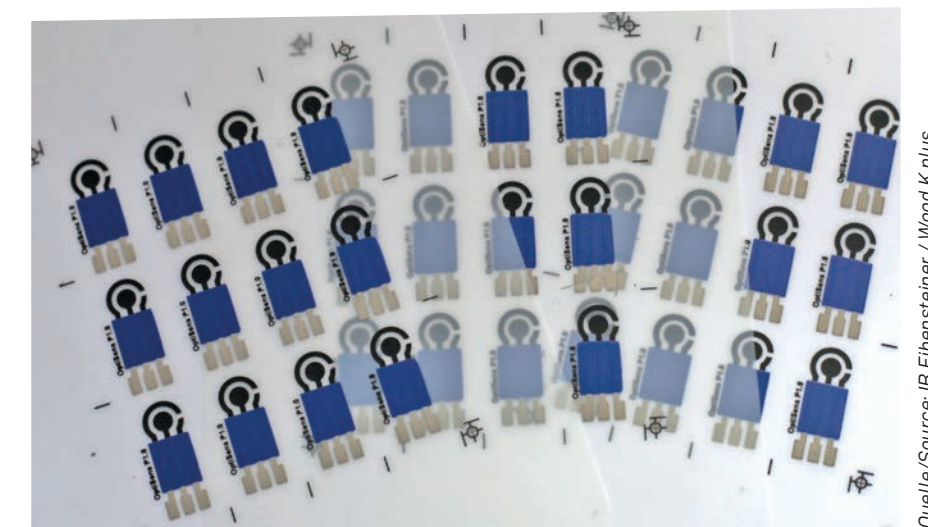
Abb. 15: Prototyp eines Impedanzsensors mit integriertem Temperatursensor (oben), Teildruck einer pH-Elektrode auf PET (unten), PANI-Schicht wird auf der runden Arbeitselektrode elektrochemisch abgeschieden Fig. 15: Prototype of an impedance sensor with integrated temperature sensor (top), partial print of a pH electrode on PET (bottom), PANI layer is electrochemically deposited on the round working electrode
