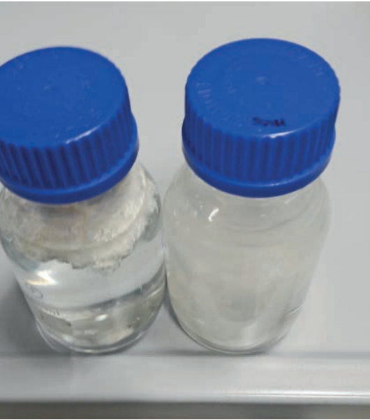
Abb. 12: Links: Wasserabweisende Faser, rechts: unbehandelte Faser Fig. 12: Left: waterproof fiber, right untreated fiber
