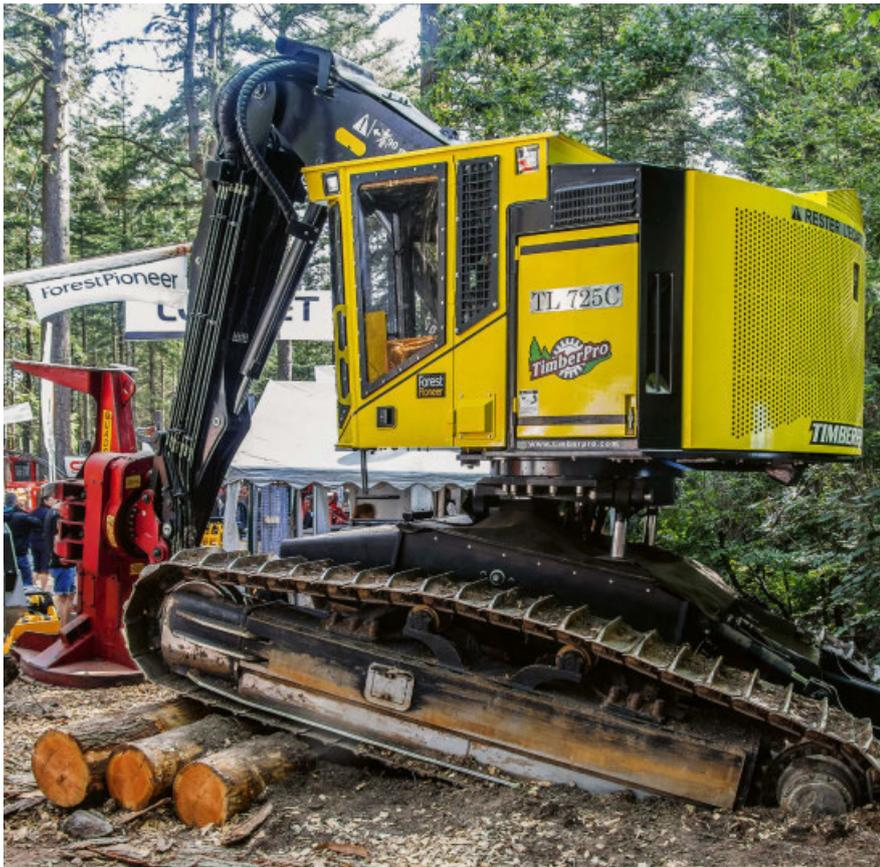
Die Hubleistung des Krans ist mit 3 t bei 9 m Reichweite eine der Stärken des vom US-Hersteller TimberPro entwickelten TL 725C. Voll ausgestattet wiegt die 300 bis 320 PS starke Maschine 30 t. Die Kabine lässt sich um 360° drehen, und am Kran lassen sich sowohl klassische Harvesteraggregate als auch Fällbündler (Feller buncher) montieren. Zwei solcher TimberPro-Maschinen sind derzeit in der Schweiz im Einsatz, gemäss ForestPioneer, dem Importeur für Spanien, Frankreich und die Schweiz.
