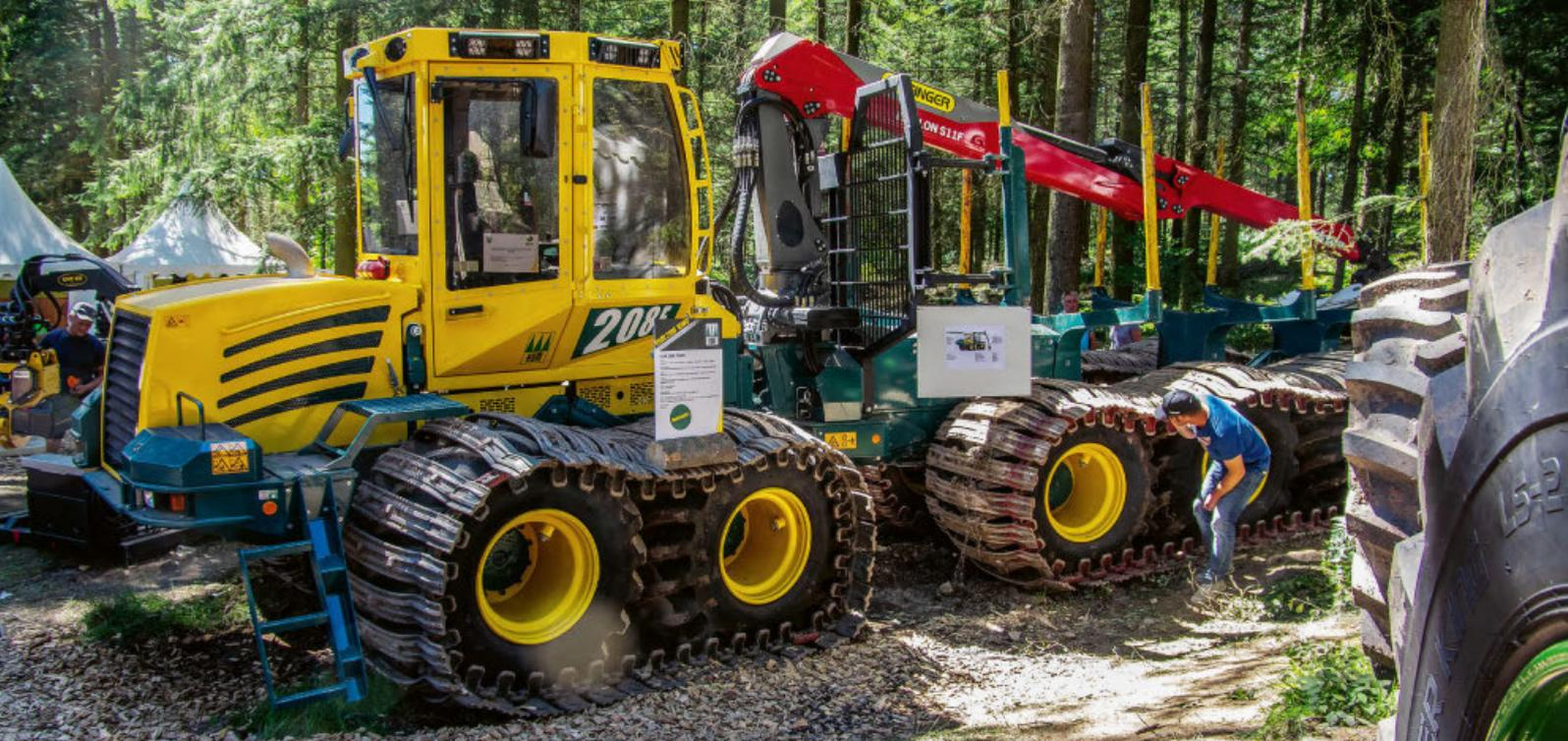
*Dieser HSM-Rückezug der Baureihe 208F verfügt neu über einen 10-Rad-Antrieb. Bei diesem Modell haben die Räder eine 25% grössere Auflagefläche als bei einem 8-Rad-Forwarder. Damit verringert sich der Bodendruck erheblich. HSM hat speziell für diese Maschine ein 3-Achs-Boogie mit versetzten Rädern entwickelt. Der Forwarder verfügt über einen Kranantrieb mit Energiespeicher, einen Energiesparmodus, ein hydrostatisches Getriebe und eine hydropneumatische Aufhängung.*
