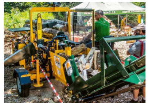
Die Hersteller von Sägespaltern müssen sich auf einem Markt mit vielen Anbietern behaupten. Auf der Euroforest war sogar der kanadische Hersteller Cordking mit dem Modell MS 20-30 vertreten. Der Sägespalter verarbeitet 1,5 bis 2 cord Brennholz pro Stunde, d. h. 5 bis 7 Ster (cord ist ein in Nordamerika gängiges Mass für Scheit- und Industrieholz. 0,276 cord entsprechen etwa einem Ster Scheitholz).
