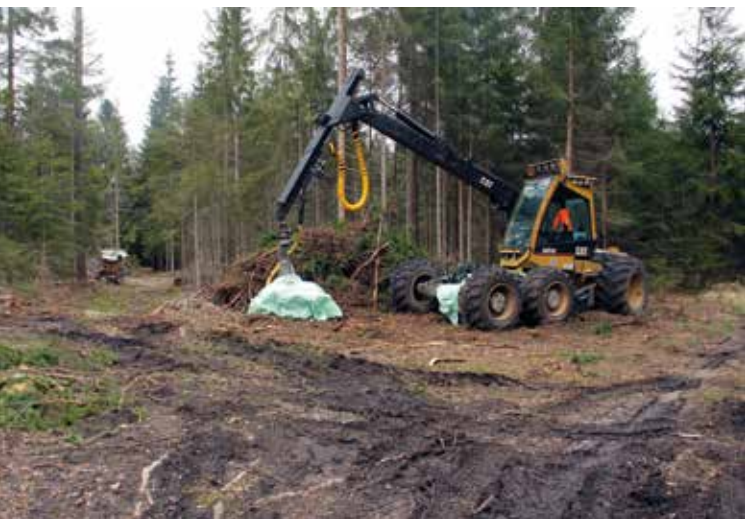
Abbildung 17: Schwere Holzrötmemaschinen verursachen Bodenverdichtung und führen damit zu verringertem Wurzelwachstum. (Foto: H. Kirchmeir)
