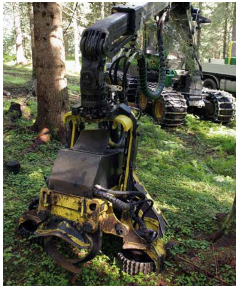
Abbildung 28: Der Einsatz von schweren Erntemaschinen („Harvester“) reduziert deutlich den Arbeitsaufwand der Holzernte, führt aber zu Verlust von Arbeitsplätzen und stärkerer Bodenverdichtung. (Foto: H. Kirchmeir)
