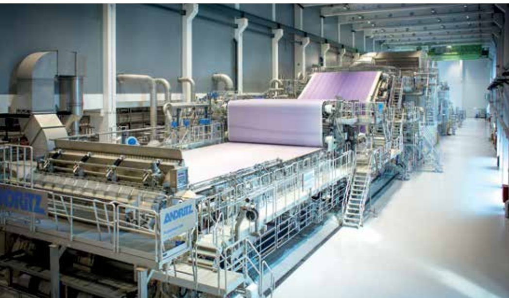
Die Maße der modernsten Papiermaschine Europas: 100 m lang, 6 m breit und 2.500 to schwer.
