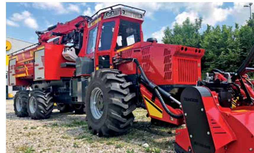
Der Multi-Fire-Truck (MFT) der slowenischen Maschinenbauer Bijol d.o.o. ist ein geländegängiges, belastbares Löschfahrzeug in modularer Bauweise auf Basis eines Forwarders.
