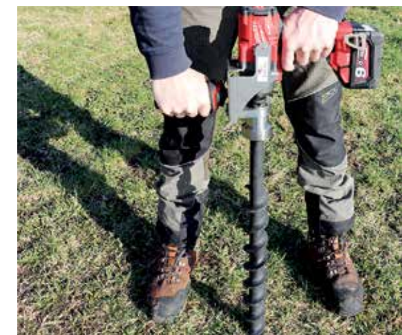
Durch die robuste Lagerung im DrillFast von BaSt-Ing wirken keine Quer- oder Längskräfte auf den Schlagschrauber. Foto: bast-ing.de
