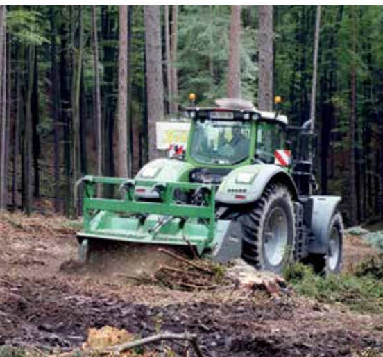
Mulchen von Schlagabraum und Baumstößen - der Forstmulcher von Steinwendner im Einsatz.
