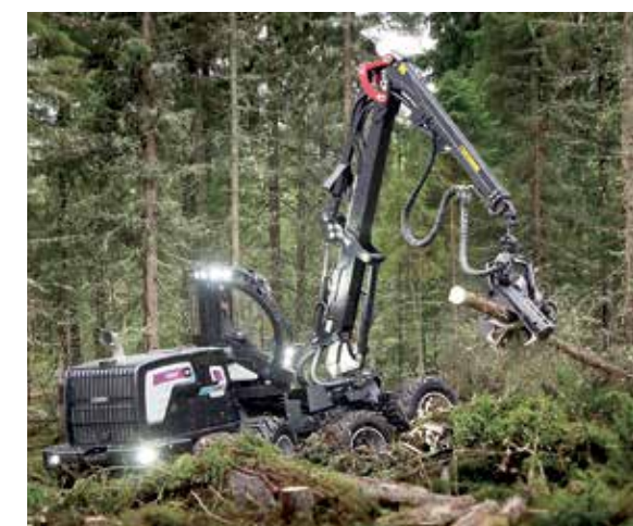
Hybridtechnologie vom Feinsten zeigt MHD mit dem neuen Harvester Logset H8 Hybrid. Höhere Effizienz bei geringerem Kraftstoffverbrauch und CO 2 -Ausstoß. Foto: Logset.com
