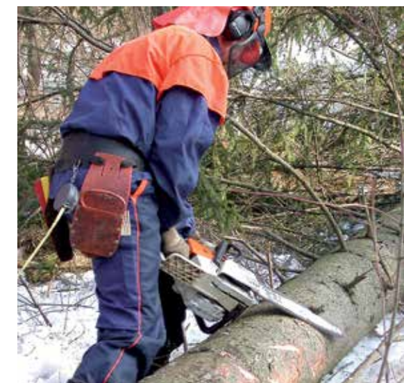
Das Gewicht der Säge liegt am Stamm.
