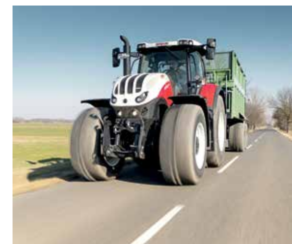
Steyr S-Brake soll das "Einknicken" des Gespanns bei Verzögerung über Motor und Getriebe verhindern. Foto: Steyr
