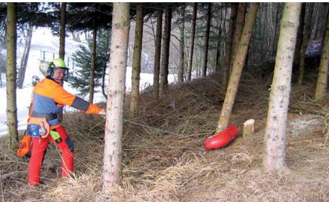
Ein Fällboy erleichtert das Umziehen von Schwachholz.
