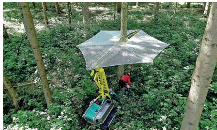
Das Pflanzel-Personen-Schutzdach wird auf der Forstraup Moritz montiert und bietet der bedienenden Person Schutz vor herabfallenden Ästen und Zweigen.
