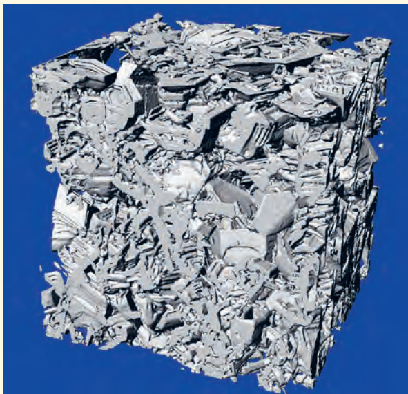
Mikro-Computertomographie einer Schneeprobe aus der Arktis: Bei der Interpretation von Fernerkundungsdaten muss die Mikrostruktur berücksichtigt werden.
