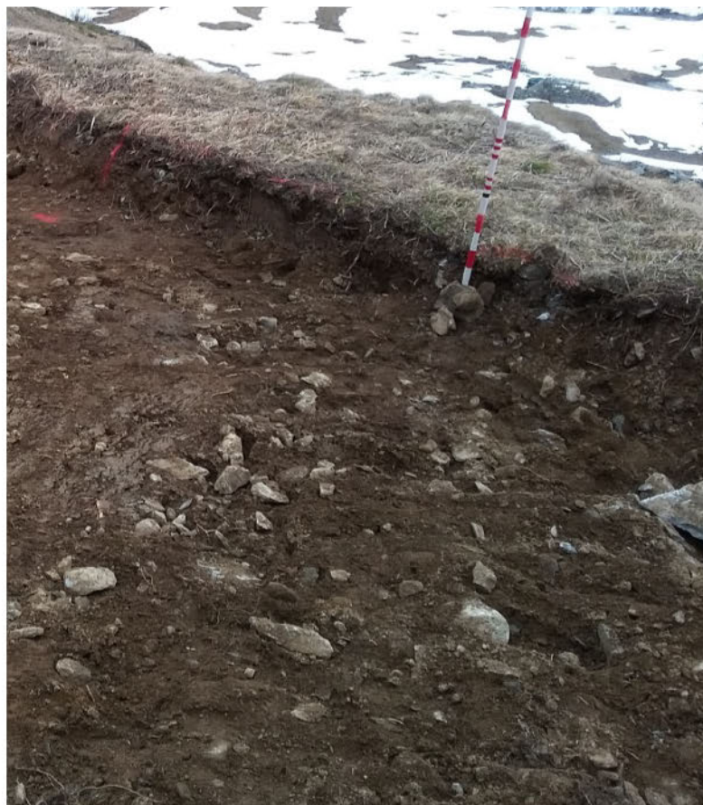
Abbildung 8: Eindeckung auf dem Galeriedach ungestört am Rand und für Fallversuche vorbereitet in der Mitte.
