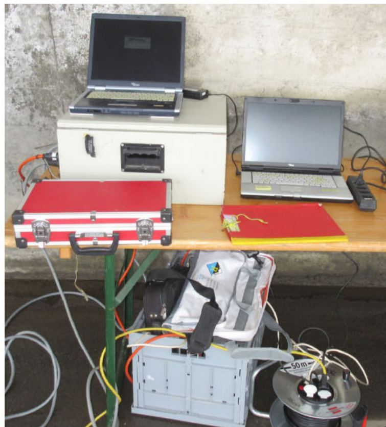
Abbildung 17: Zentrale Datenerfassung und Triggerung der Messtechnik.
