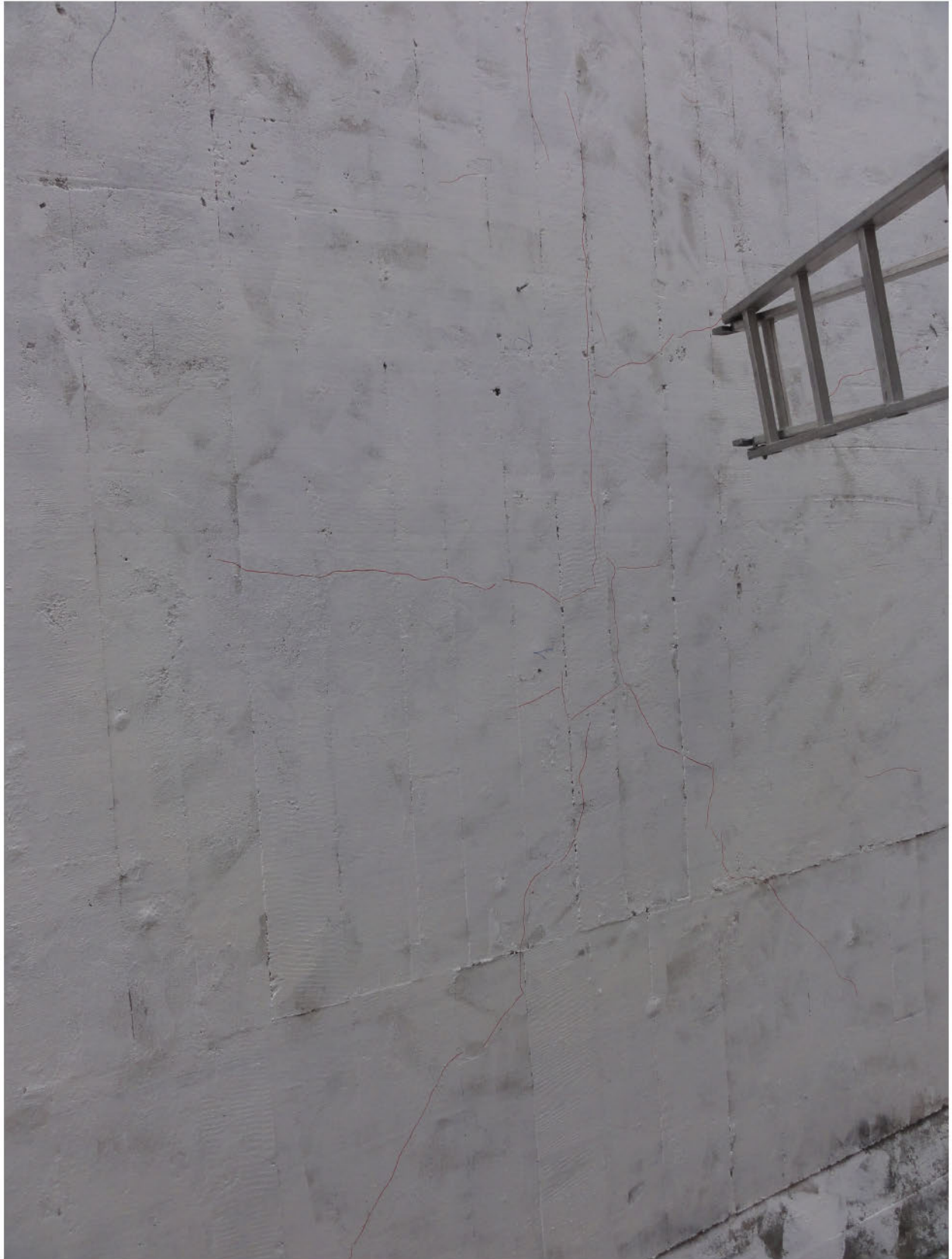
Abbildung 50: Rissbild an Unterseite des Galeriedachs infolge Versuch P31 (schwarz = vor dem Versuch, rot = nach dem Versuch).
