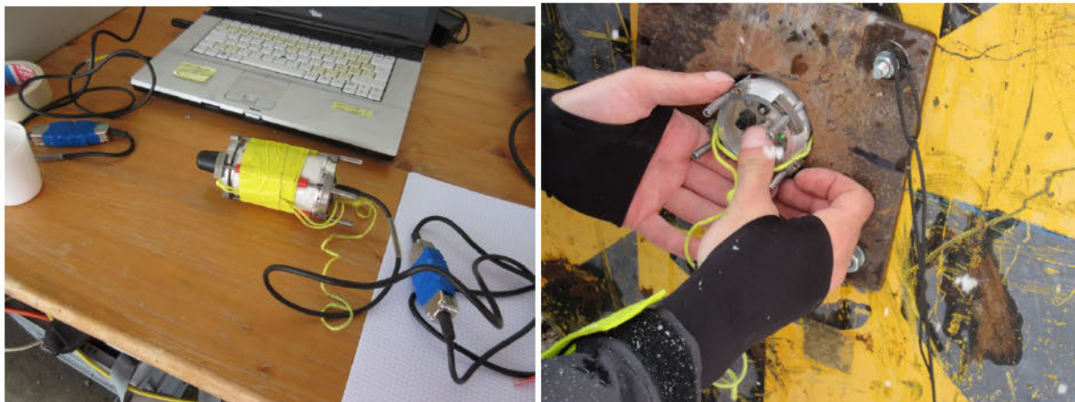
Abbildung 15: Zusätzlicher versuchsweise eingesetzter Sensor zur Montage im Wurfkörper.
