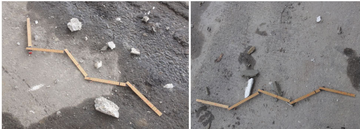
Abbildung 49: Abplatzungen infolge Versuch P31.
