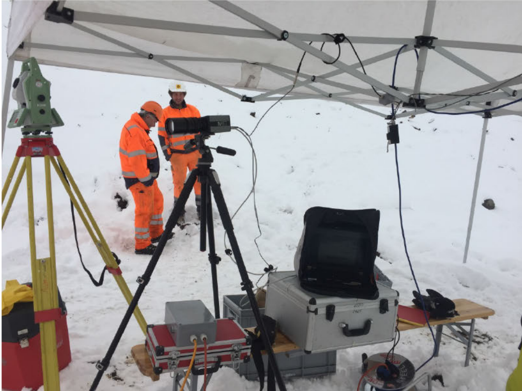
Abbildung 16: Auf dem Galeriedach installiertes Videosystem mit aufgestelltem Tachymeter unter dem Wetterschutz-Pavillon.
