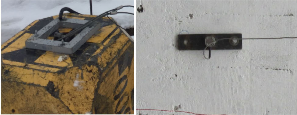
Abbildung 14: Montage der Beschleunigungsgeber an Wurfkörper und Unterseite des Galeriedachs. Der Stahlrahmen bzw. die Stahlplatte werden mit Einschlagankern am Beton befestigt.
