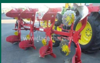
3254 Bergland 0676/83909272 Pöttinger Servo 35 S Pflug Bj. 2017, 4 Schare, hydr. Drehpflug, hydr. Schnittbreitenverstellung, Stützrad, Maiseinleger 18.900,-*
