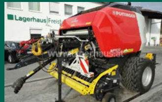
4240 Freistadt 0664/32 59 280 Pöttinger Impress 3160 V Pro Bj. 2022, Vorführpresse, ca. 600 Ballen, Druckluft, Netzbindung, Anzahl Messer: 32, Pick-Up Breite: 230 cm 79.900,-*
