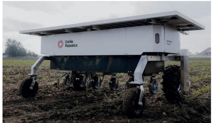
Der Roboter von Dahlia Robotics ermöglicht eine vollautonome In-Row-Beikrautregulierung bei Hackfrüchten.
