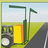
**Effiziente Gestängeklappung:** Bessere Haltbarkeit und mehr Sicherheit weil das Klappsystem nach oben und nicht nach hinten funktioniert! Bei Hindernissen im Feld ergibt sich dadurch Zeit- und Wegersparnis!
