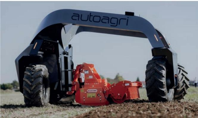
Autonome Trägerplattformen wie jene der Firma Autoagri aus Norwegen erlauben die Aufnahme von Standardgeräten für autonome Feldarbeiten.
