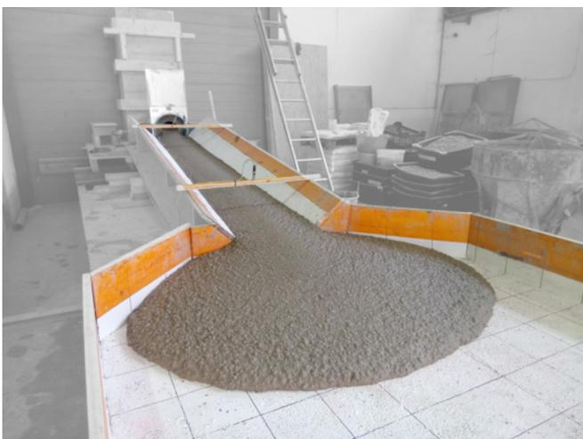
Abb. 12. Ablagerungen eines 20000 m<sup>3</sup>-Murgangs im Modell im Massstab 1:25 im Laboratorium3D.
