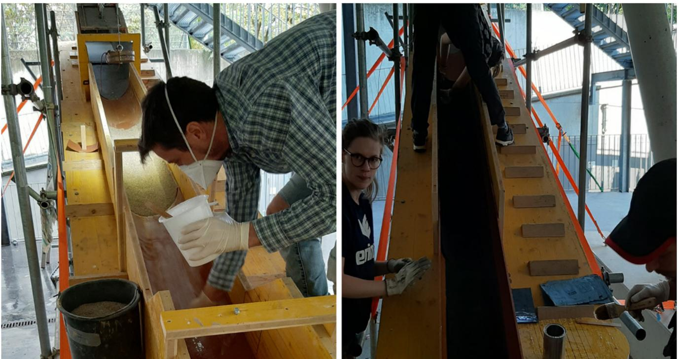
Abb. 5. Einbauen der massgeblichen Rauigkeiten in die Murgang-Versuchsrinne.
