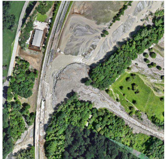
Abb. 3. Ablagerungen (ca. 45 000 m<sup>3</sup>) am Fuss des Val d’Orbel-Kegels bei Soazza (GR) und Umleitung der Moesa nach dem Ereignis im Juni 2024. Fliessrichtung der Moesa von rechts nach links.
