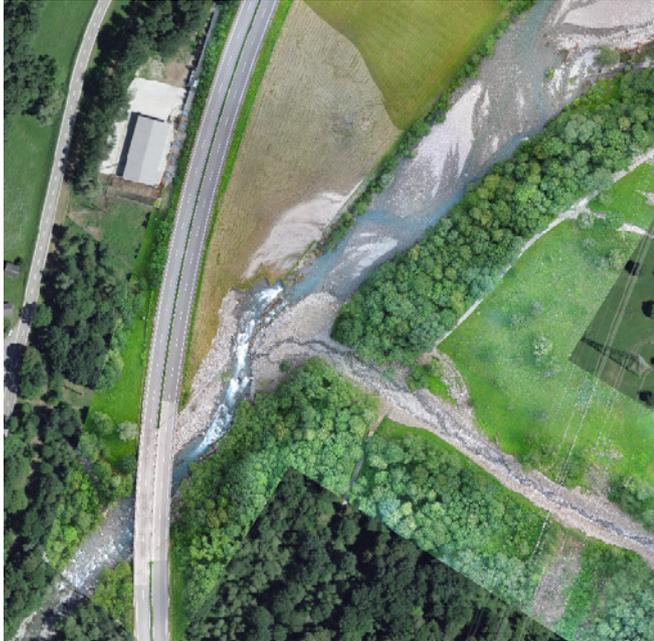
Abb. 1. Ablagerungen (ca. 20 000 m<sup>3</sup>) am Fuss des Val d’Orbel-Kegels bei Soazza (GR) und Umleitung der Moesa nach dem Ereignis im Juni 2019. Fliessrichtung der Moesa von rechts nach links.
