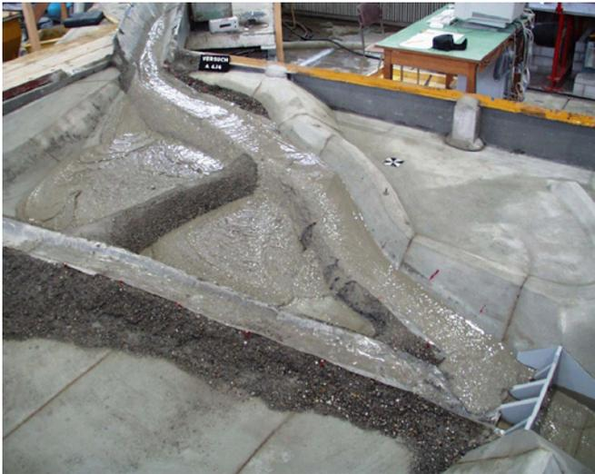
Abb. 11. Rückhaltebecken der Maschänserrüfe (GR) im Modell 1:60 an der VAW (siehe Schatzmann *et al.* 2007).
