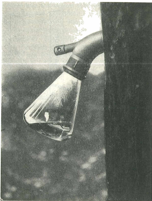
Abb. 2. Ansicht des am Stamme festgeschraubten Harzgefäßes.
