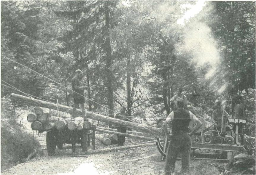
Abb. 3. Das aufgeseilte Bloch wird mit Hilfe des Seilgerätes auf den Blochwagen verladen.
