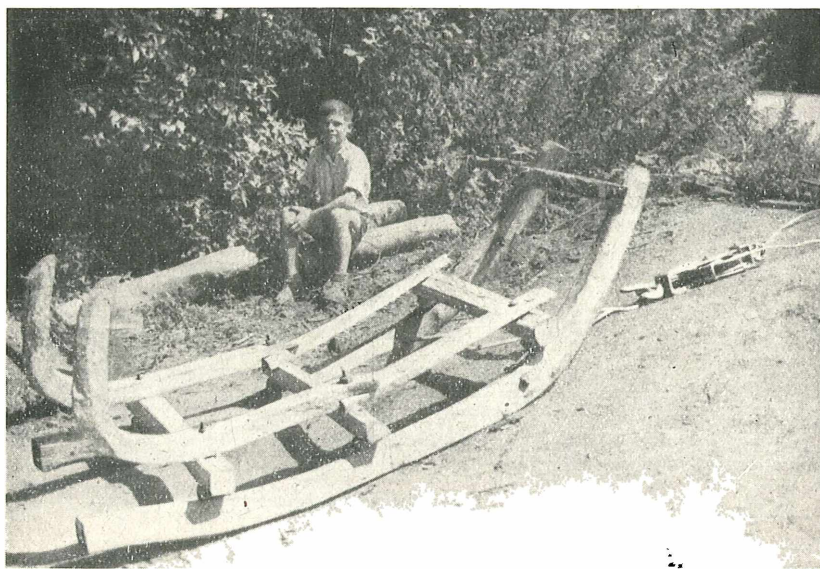
Abb. 10: Mager'scher Schlitten zum Aufseilen und Rücken von Schichtholz.
