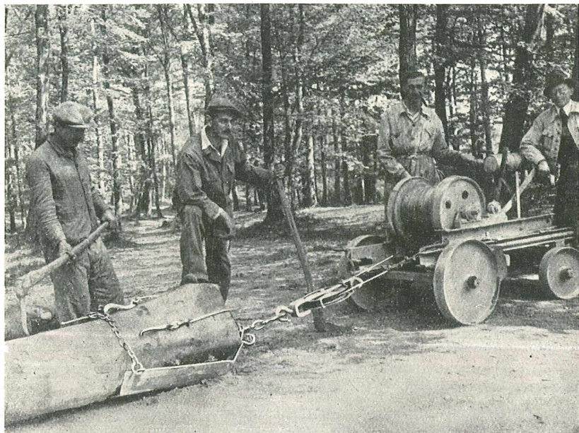
Abb. 1: Rücken eines mittelschweren starken Buchenbloches mit 30 cm Sekundengeschwindigkeit (mit eingeschalteter loser Rolle). Die Maschine ist neben der Abfuhrstraße durch einen um einen Baum mehrfach gelegten Strick verankert.
