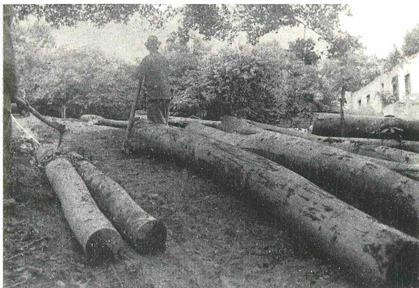
Abb. 8: Aufseilen von zwei Buchenschwellenblochen zugleich und nebeneinander mit 60 cm Geschwindigkeit. Ganz links auf dem Bilde der Standpunkt der Maschine an der Straße.
