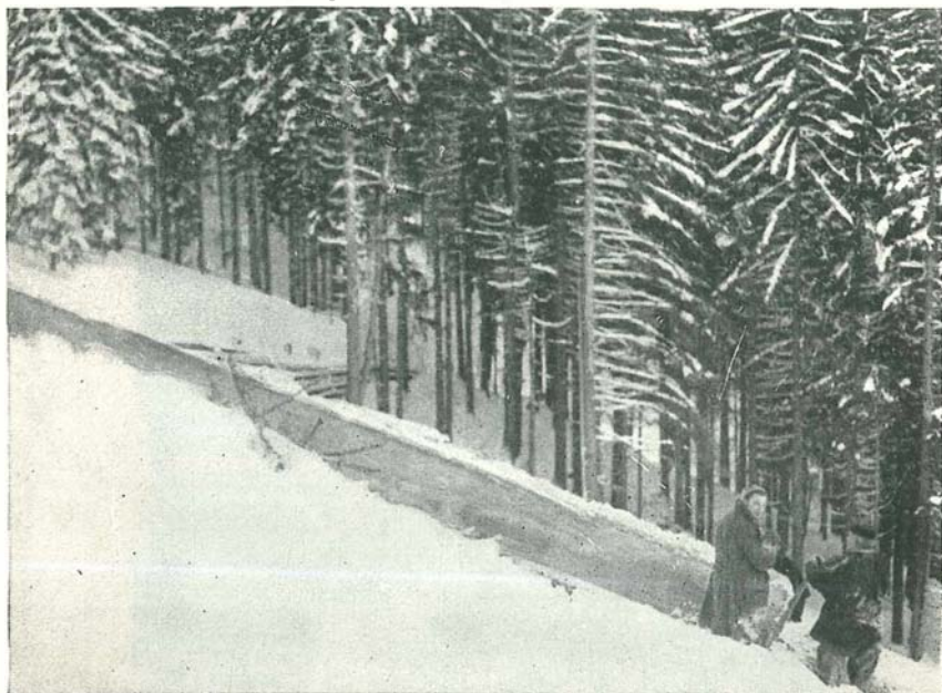
Abb. 58: Rücken eines Stammabschnittes mit der Mariabrunner Abseil- und Rückmaschine. Stellenweises Flottmachen des durch Schlaghindernisse in seiner Bewegung gehemmten Holzes.
