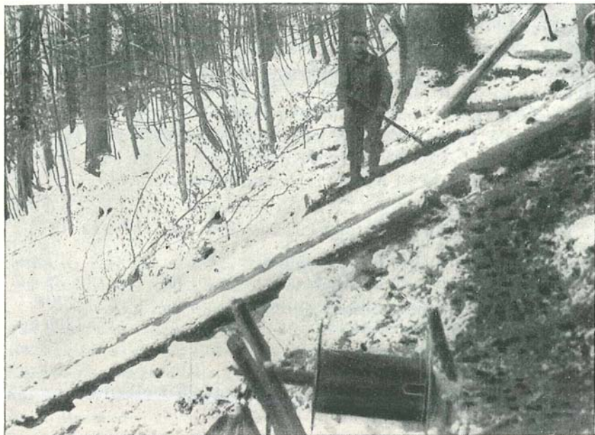
Abb. 16: Seilvorrats- und Transporttrommel, vom Standpunkte der Maschine aus seitwärts gegen die Einkehr zu gesehen.
