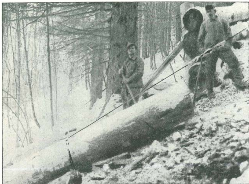
Abb. 39: Abseilen eines Stammabschnittes. Die Verbindungsstelle zwischen Förderseil und Binde-seil am Bilde ersichtlich.
