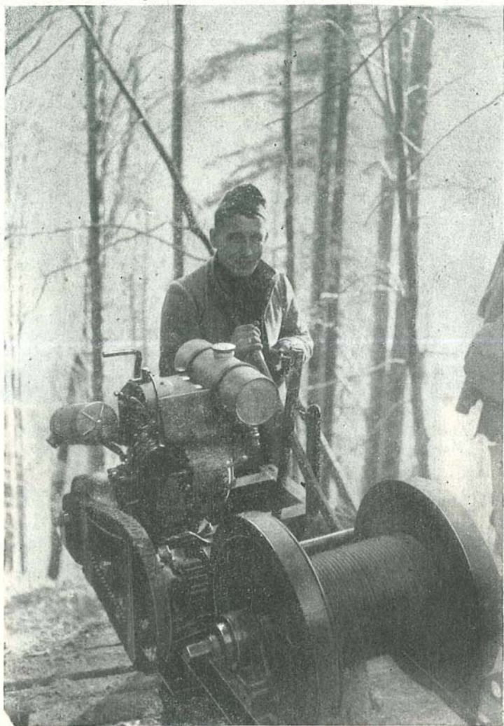
Abb. 51: Arbeitsstellung der Maschine bei Ankunft der Nutzlast am Verleerplatz. Diese wird durch die Bremsvorrichtung allmählich zum Stillstand gebracht.
