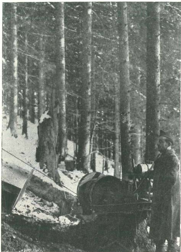
Abb. 37: Mariabrunner Abseil- und Rückmaschine, auf einem Stocke drehbar verankert. Maschine in Arbeitsstellung beim Aufziehen des leeren Seils samt den Befestigungsmitteln. Motor in Arbeit; Vorgelege eingerückt; Bremsband gelüftet; Bremshebel am Bremshebelträger aufgelegt.
