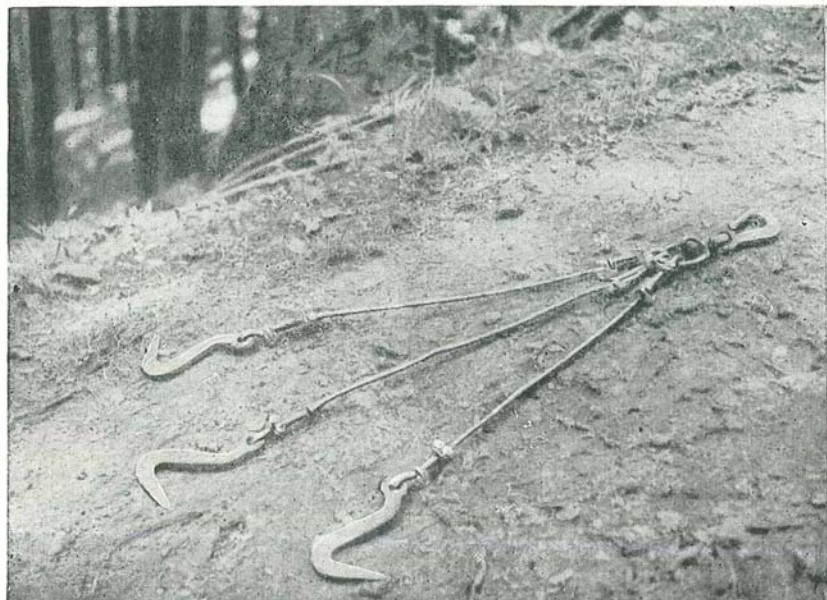
Abb. 57: Spezial-Hakel- oder Schleppzeug mit Seilschlenken und Jaidhofer Schlepphaken.
