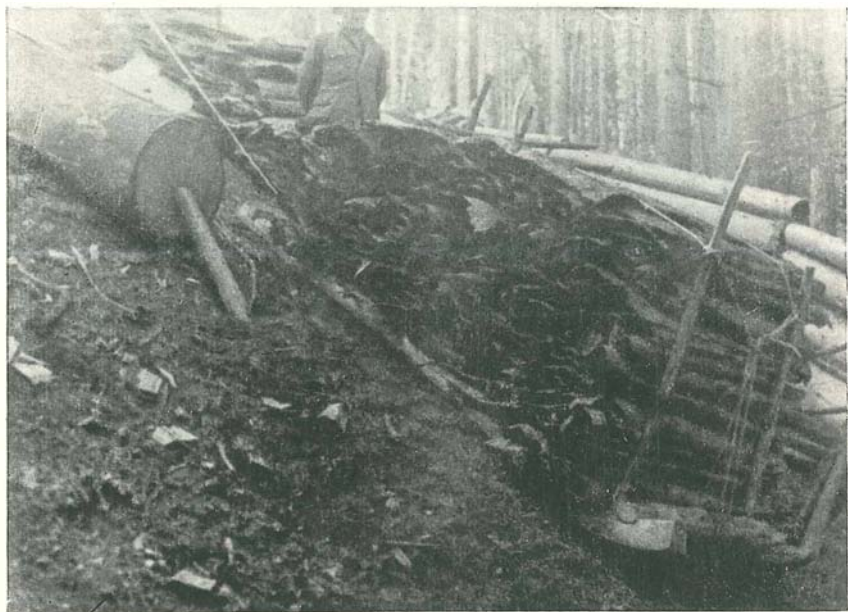
Abb. 34: Abseilen von Rinde auf Förderschlitten. Ansicht der Nutzlast von unten.
