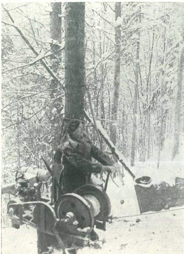
Abb. 61: Aufziehen des leeren Seils samt den Befestigungsmitteln über die Schlagfläche; ausnahmsweise durch Menschenkraft mit Zuhilfenahme des Handkurbelantriebes der Maschine.
