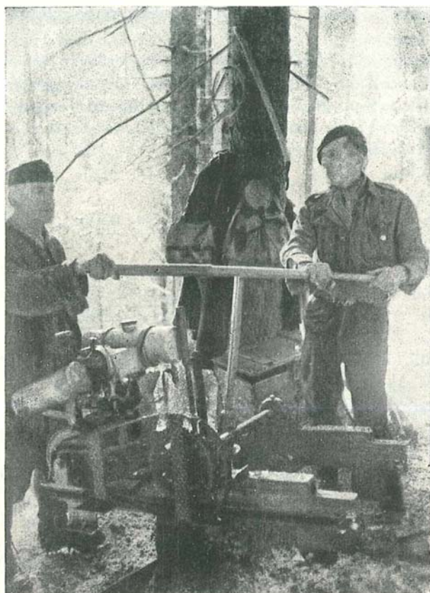
Abb. 13: Verankerung der Maschine auf einem Stocke. Eindrehen der Grundschaube mit einem Steckschlüssel zur Befestigung des Grundbaues. An der Handhabe des Schlüssels beiderseits angefügte abnehmbare Verlängerungsstücke.
