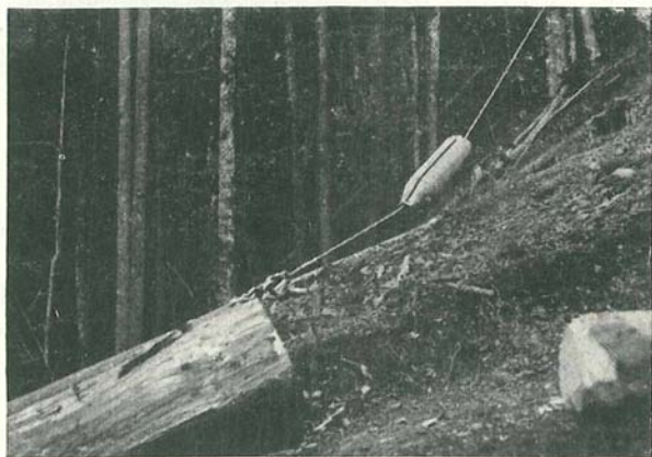
Abb. 56: Leerer Behälter für die Befestigungsmittel, beim Abseilen der Nutzlast am Förderseile hängend. Betriebsstellung bei der Einkehr der Versuchsstrecke im Kaltengraben des Forstverwaltungsgebietes Weyer.
