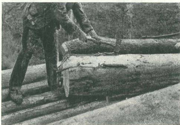
Abb. 47: Spezial-Hakelzeug mit drehbarem „Umgang“, Drahtseilschlenken und Doppelhaken. Es hat bei der Erprobung bezüglich der Haken nicht befriedigt.
