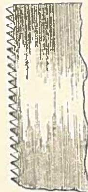
Fig. 27. Rückensäge. Verticalprojection und Seitenansicht; Querschnitt d. Bl.
