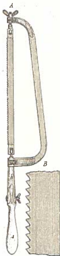
Fig. 48. Die Müller-Dörmer'sche Flügelsäge am geraden Handgriffe. A. Ansicht. B. Bezeichnung. A. in 0·15; B. in 0·75 der nat. Gr.
