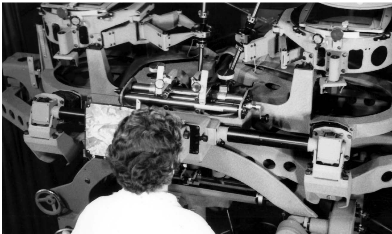
„Analoges 3D-Verfahren“: Mit der Triangulation wurden im Bereich der Forstinventur Daten zum österreichischen Wald optisch vermessen. Nach erfolgreicher Waldstandsaufnahme von 1952–56 wurde die Messtechnik ab 1957 laufend den Anforderungen angepasst.
