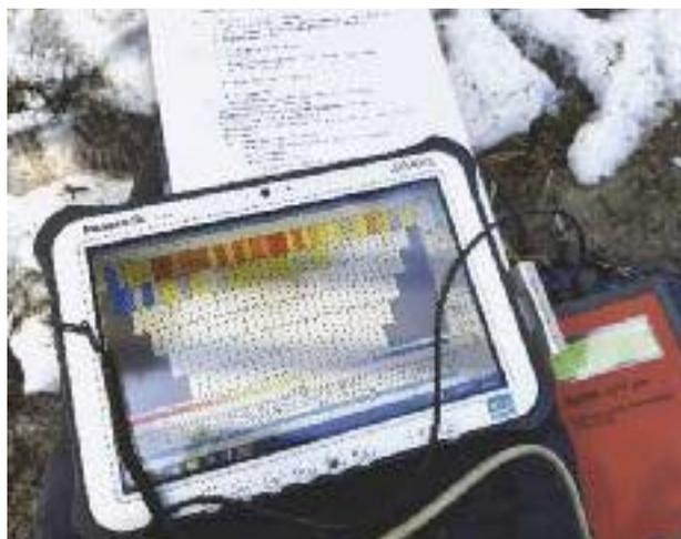
↑ Aufbruch: In den Containern befinden sich die Sonden. ↗ Ein hoher elektrischer Widerstand wird in blau (= wenig Bodenfeuchte) dargestellt, ein geringer in Rot (viel Bodenfeuchte).
