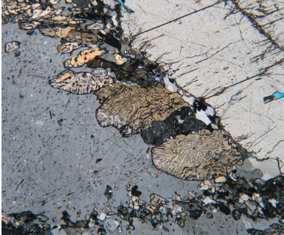
Spuren im Gestein: Mikroskopische Aufnahme eines Gesteinsdünnschliffes mit Spodumenkristallen
