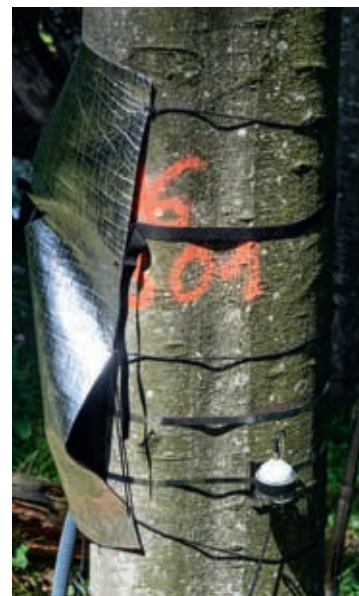
Forschungsobjekt Baum: Sensoren zeigen an, wenn der Baum unter Trockenstress leidet.
