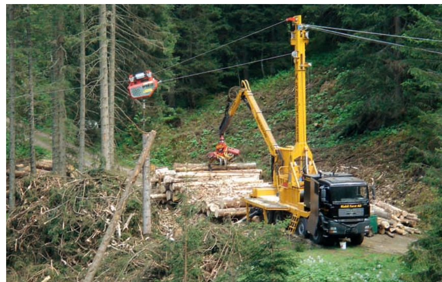
Waldstrassen sind die Voraussetzung für den Mobilseilkrane, der hauptsächlich im Alpenraum eingesetzt wird.
