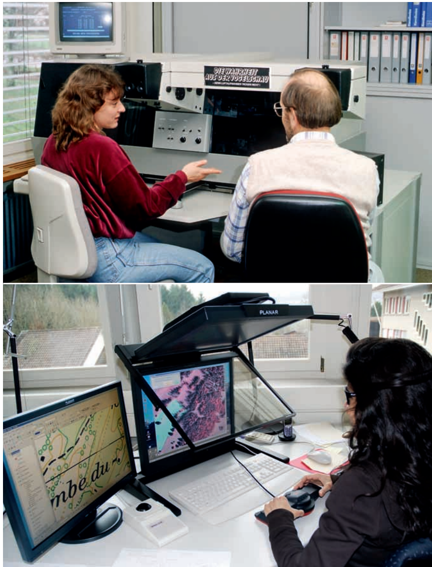
Wurde im LFI2 für die stereoskopische Luftbildinterpretation ein Spezialgerät benötigt, kann diese heute an einem handelsüblichen PC mit speziellem Bildschirm erfolgen.
