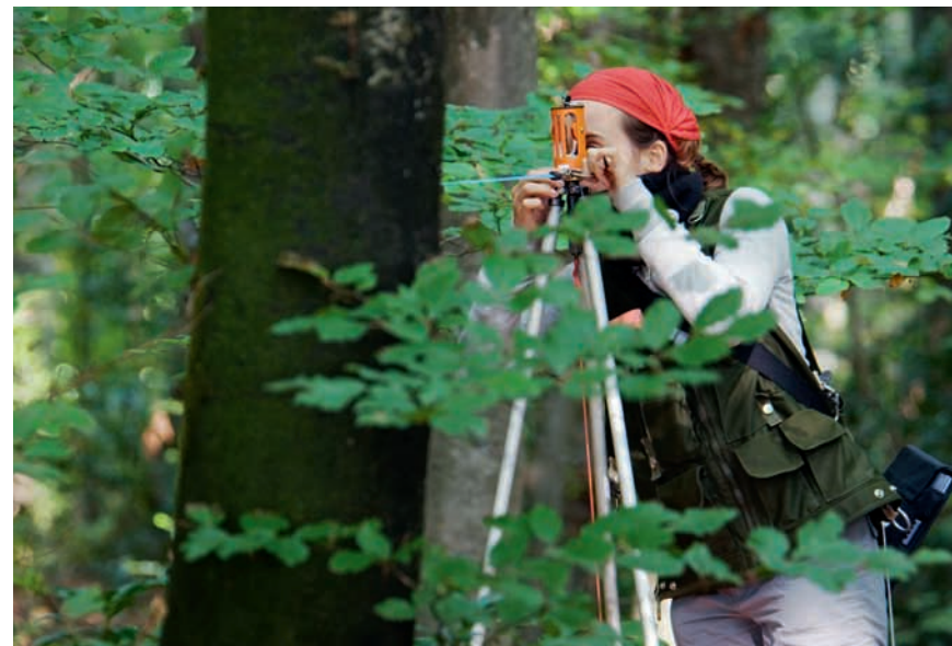
Mit Wyssen-Kompass und Messband werden Azimut und Distanz der Bäume zum Probeflächenzentrum gemessen.
