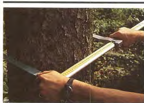
Messung des Durchmessers in 1,3 m Höhe (Brusthöhendurchmesser BHD)
