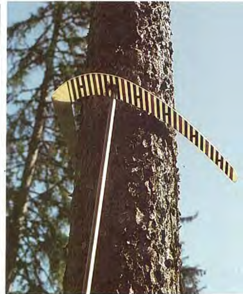
Messung des Durchmessers in 7 m Höhe: d_7 = 38 \text{ cm}
