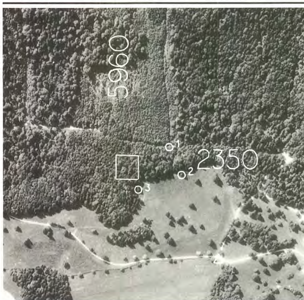
Luftbild der Waldprobestfläche mit den Koordinaten 596 000/235 000. Das Viereck umhüllt die Interpretationsfläche von 50 x 50 m. Die nummerierten Kreise sind Fixpunkte, die zur Einmessung des Probestflächenzentrums im Gelände dienen.
