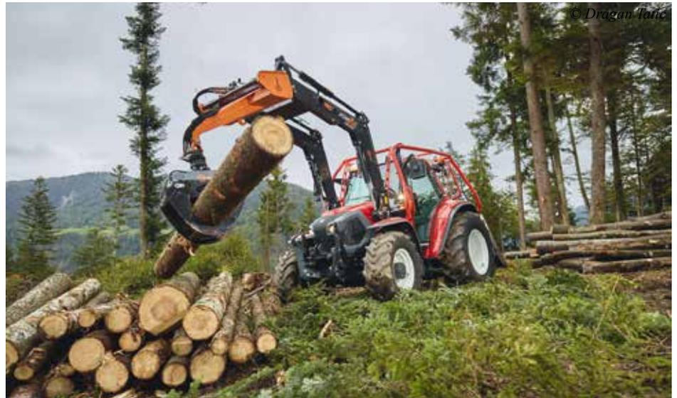
ren. Ein weiteres Highlight: Die Heckhydraulik ist beim Lintrac 110 mit Hub und Druck verfügbar. Das kommt besonders bei Forstarbeiten mit starken Seilwinden zum Tragen. Die 4-fach-Heckzapfwelle mit Anlaufsteuerung arbeitet wahlweise mit 430/ 540/ 750 oder 1000 U/min. Die Heckhydraulik hebt 4.900 Kilogramm, die Fronthydraulik 2.500 Kilogramm. Das höchstzulässige Gesamtgewicht liegt bei acht Tonnen, die Nutzlast bei rund 3,5 Tonnen. Für komfortables Arbeiten steht die größere TracLink-Kabine.
