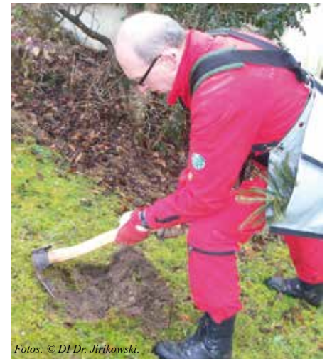
Kurzstielige Pflanzhaue mit löffelförmiger Haue und Schlagplatte nach Forstwirtschaftsmeister Thomas Als (Zeughammerwerk Leonhard Müller & Söhne, Frantschach)
