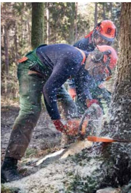
Abbildung 3: Sicherer Aufenthaltsort außerhalb des Schwenkbereichs der Motorsäge wählen (@Wahlhütter)!
