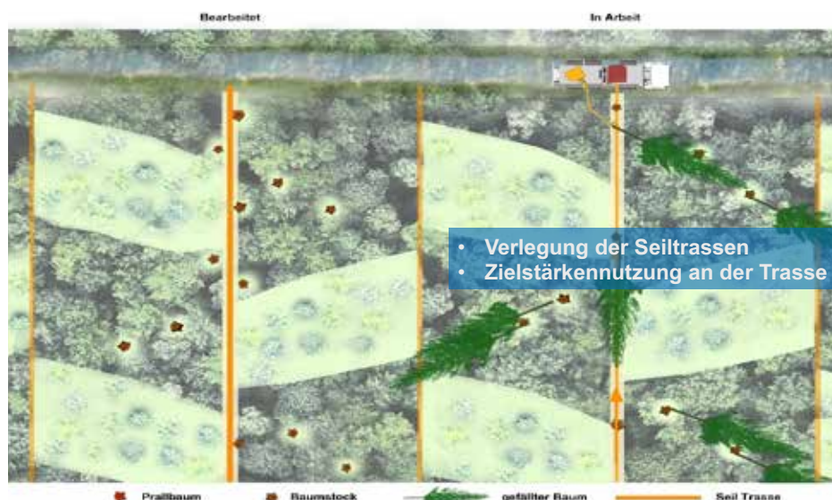
Abbildung 4: Verlegung der Seiltrassen und Zielstärkennutzung (dritter Eingriff).
