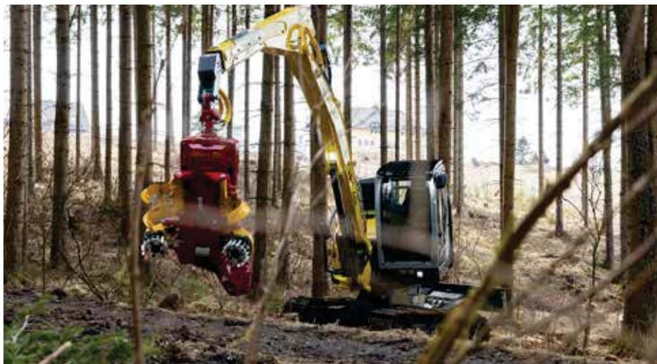
licht ebenso ein Manipulieren von größeren und schwereren Stämmen. Wahlweise ist der WOODY 40 mit dem bewährten KONRAD-Endlosrotator oder mit Indexator AV 4E I erhältlich. Für Trägerfahrzeuge wie z.B. Kombi-schlepper ist ein vernünftiges Wechselsystem, bei dem der Rotator am Teleausschub verbleibt, von großem Vorteil, da das Schlauchpaket für das Aggregat komplett vom Kran abgenommen werden kann und beim Starkholzrücken nicht stört.
