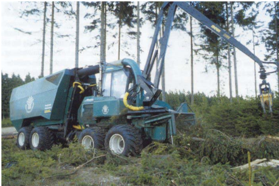
Abbildung 24: Waldhackguterzeugung aus Ernterücklässen bei einem Kahlschlag in Dänemark mit einem speziellen geländetauglichen Hackeraggregat.
