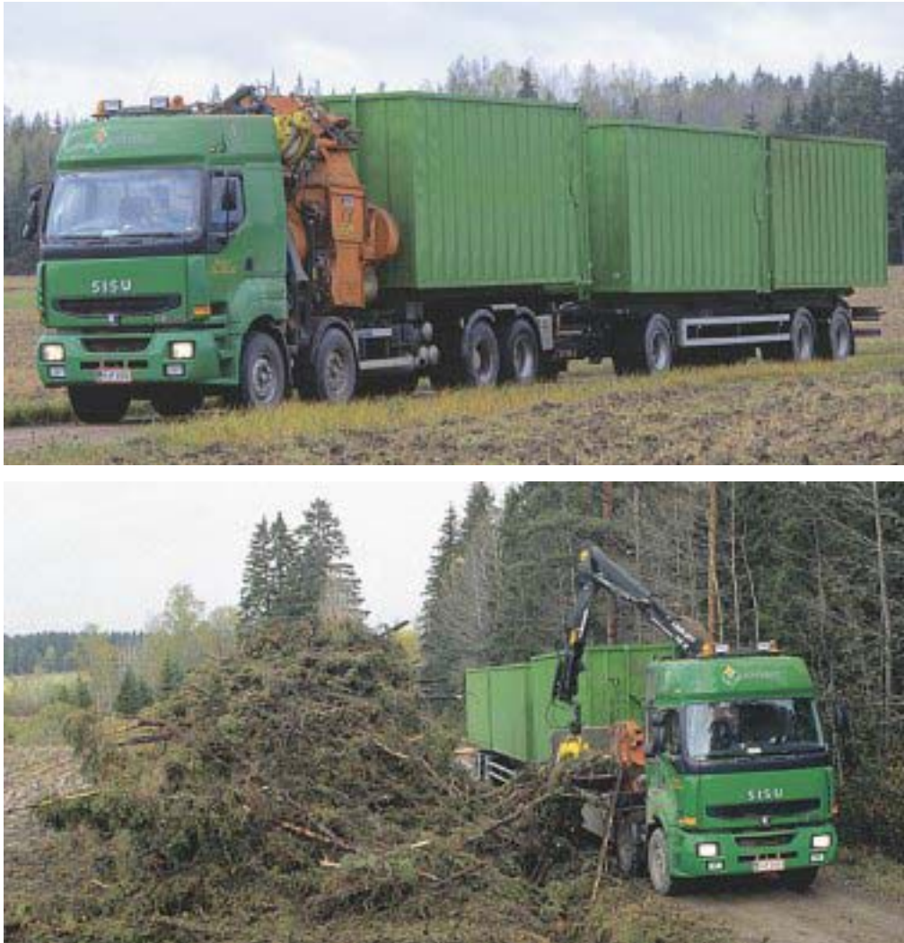
Abbildung 15: Aufarbeitung von Ernterücklässen in Finnland an einer LKW-befahrbaren Forststrasse mit einem von Biowatti Oy entwickelten Hackerkonzept. Der Spezial-LKW ist mit einem leistungsstarken Hackaggregat ausgerüstet, dadurch werden Stehzeiten bei Mann und Maschine minimiert.
