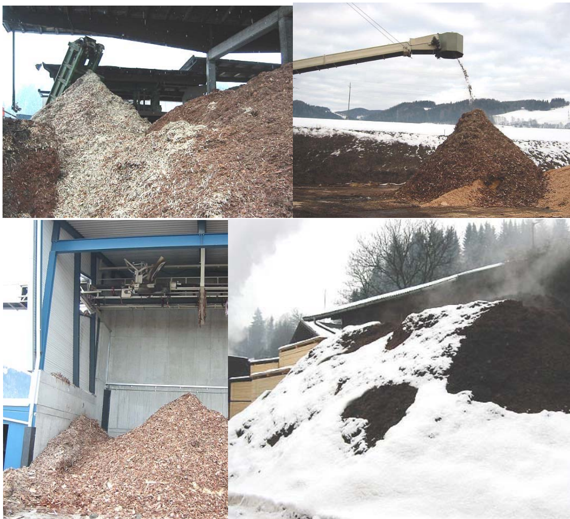
Abbildung 28: Restholzabwurf direkt aus dem Produktionsprozess bei den Energiezentralen bzw. auf dem Zwischenlagerplatz in Sägewerksbetrieben. In der Regel wird die anfallende Restholzmenge nur nach Prozentsätzen der Einschnittmengen abgeschätzt.
