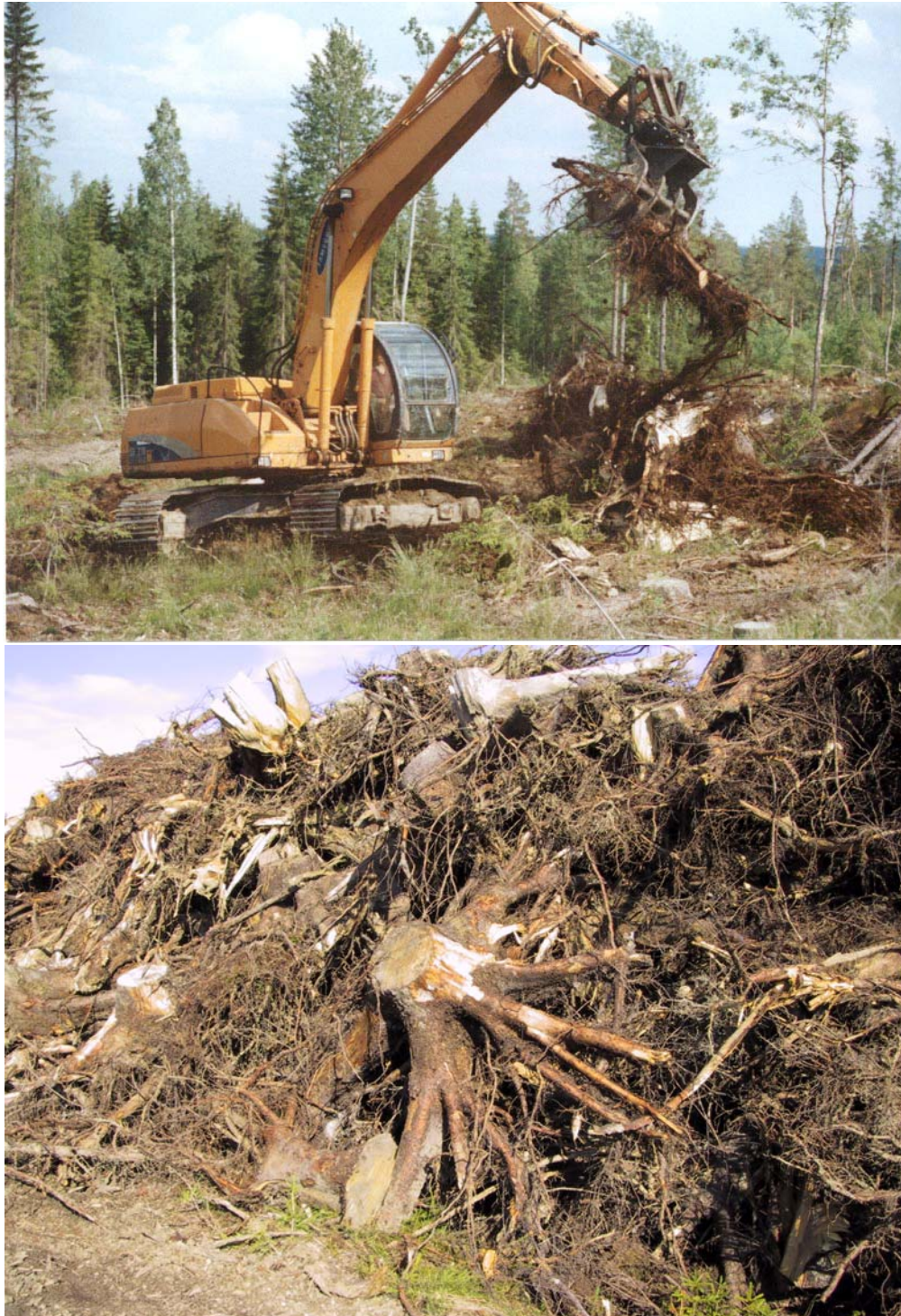
Abbildung 12: Stocknutzung für Energieholzsortimente in Finnland. In Finnland werden Endnutzungsflächen in der Regel mit der finnischen Forstegge für die Aufforstung vorbereitet, der Rohhumus wird mit der Egge aufgerissen um die natürliche Ansammlung von Rohbodenkeimern (Kiefer, Birke) zu erleichtern bzw. um den Mineralboden für die Anpflanzung mit kleinen Topfpflanzen zu erreichen. Im Fall der Stocknutzung für die Energieholzerzeugung entfällt die Bearbeitung der Fläche mit der Forstegge. Derart intensive Flächenbearbeitungen sind bei der Waldbewirtschaftung in Mitteleuropa nicht üblich.
