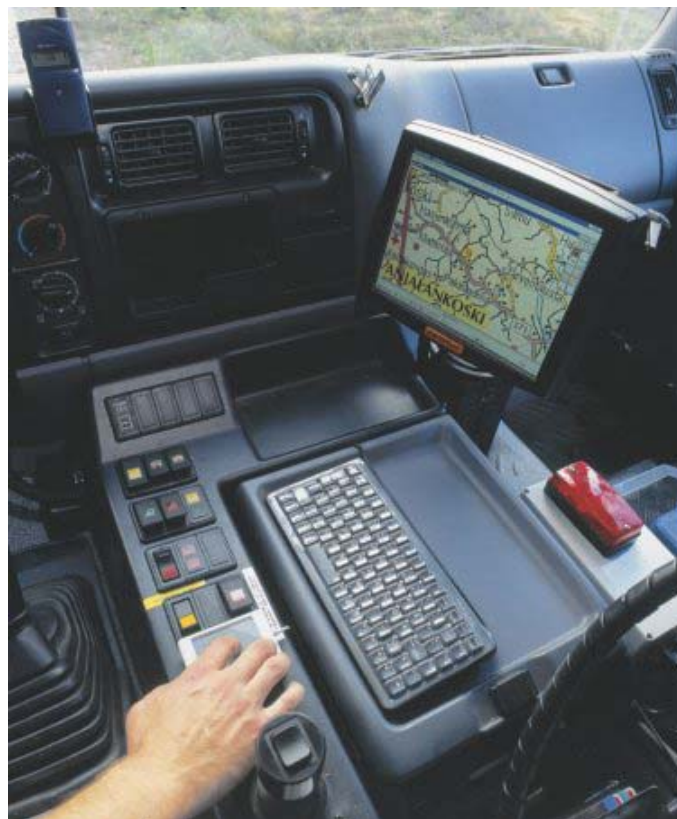
Abbildung 17: Die Ernte- und Transportmaschinen sind in Finnland heutzutage in der Regel zur Logistikoptimierung mit GPS Anlagen ausgestattet.
