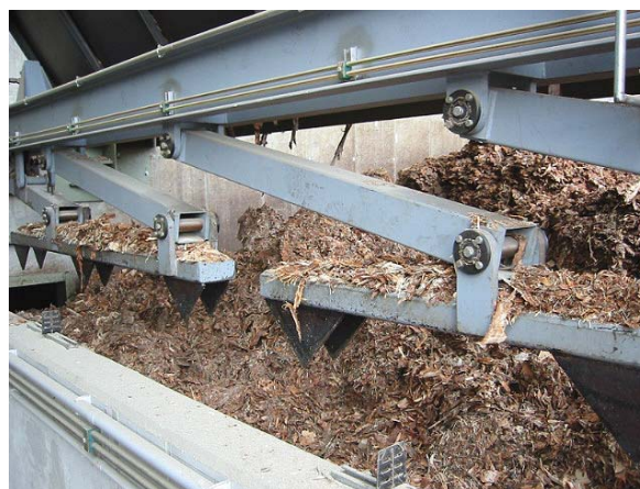
Abbildung 41: Die Stückigkeit des Brennstoffes kann (z.Bsp. Brückenbildung bei Rinde) auch bei größeren Anlagen zu Problemen mit der Brennstoffbeschickung führen.
